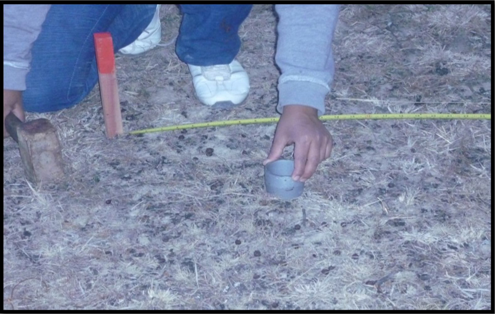
FOTO Nro. 4: Instalación de los cilindros para la obtención de muestras de suelo
