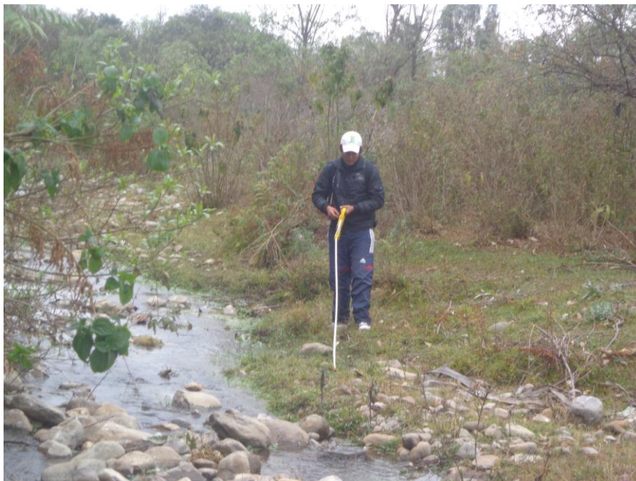
Medición de los puntos a de cada estación (medición con wincha cada 100 m)
