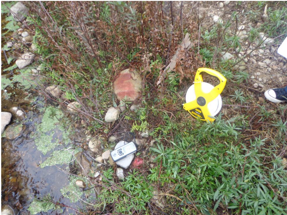
Materiales para medir las distancias y coordenadas de las estaciones de muestreo
