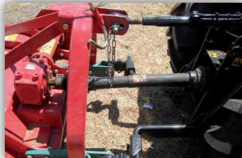
Los accidentes que suceden en los tractores que transmiten movimientos o fuerzas, a equipos acoplados a través de la toma de fuerza y ejes de carga, se deben a la pérdida de protecciones de la línea de transmisión, que se mantiene funcionando y no se ha desacoplado al momento de enganchar a la barra de tiro de un equipo o por realizar revisiones estando este en movimiento.
