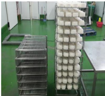
Las parrillas y estanterías para quesos son apilables, de acero inoxidable para cámaras de oreo. Las estanterías para cámaras de curados, se hacen a medida. Con armazón de acero inoxidable y placas perforadas de poliestileno, de fácil desmontaje y limpieza.
