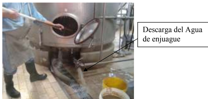
Figura 2-4 Limpieza del Sedimentador Whirlpool
