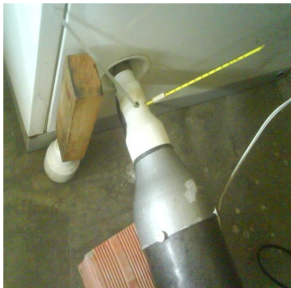
Figura 2-15 Medición del aire a la entrada del secador
