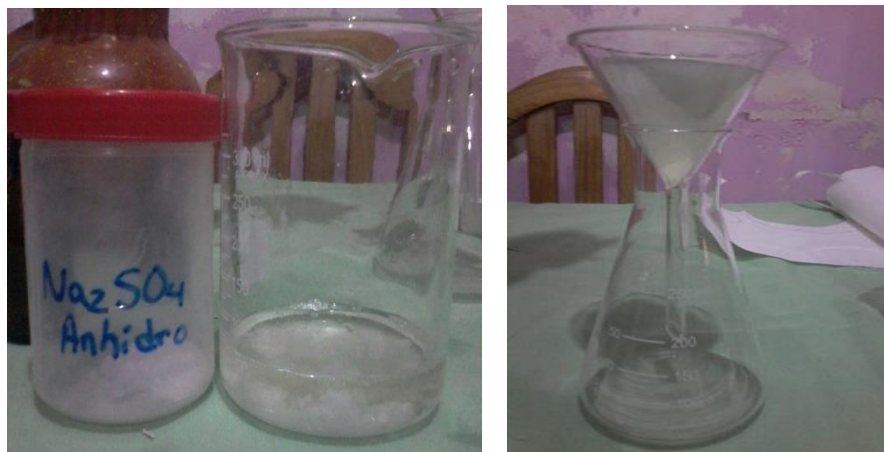
Figura 2-16 Purificación del aceite esencial de hierbabuena
