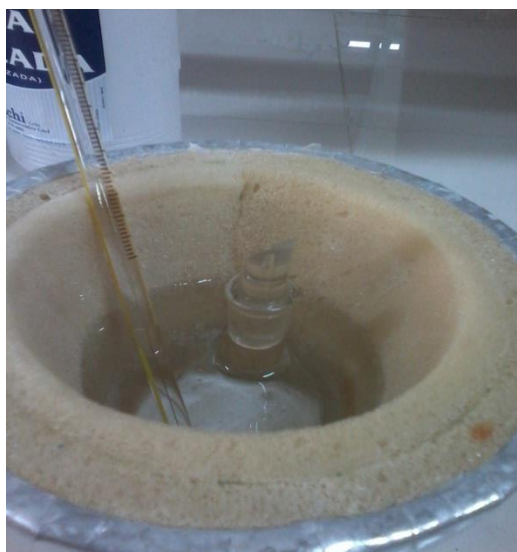
Figura 2-21 Picnómetro con agua destilada en el calorímetro a 20°C
