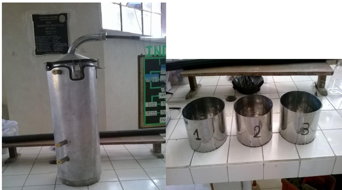
Cámara de extracción y canastillos
