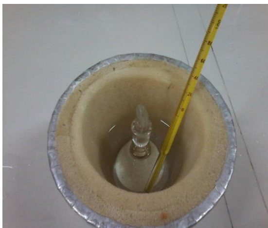
Figura 2-22 Picnómetro con aceite esencial de hierbabuena en el calorímetro a 20°C
