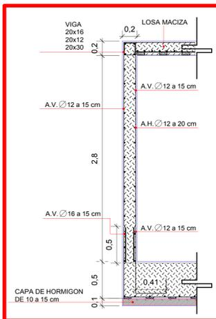
LOSA MACIZA CON CORONACION MURO DE HORMIGON ARMADO
