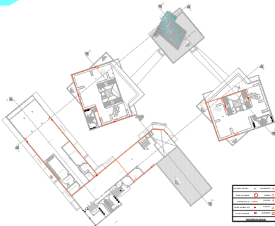
INSTALACION DE GAS PLANTA ALTA ESC. 1:150
