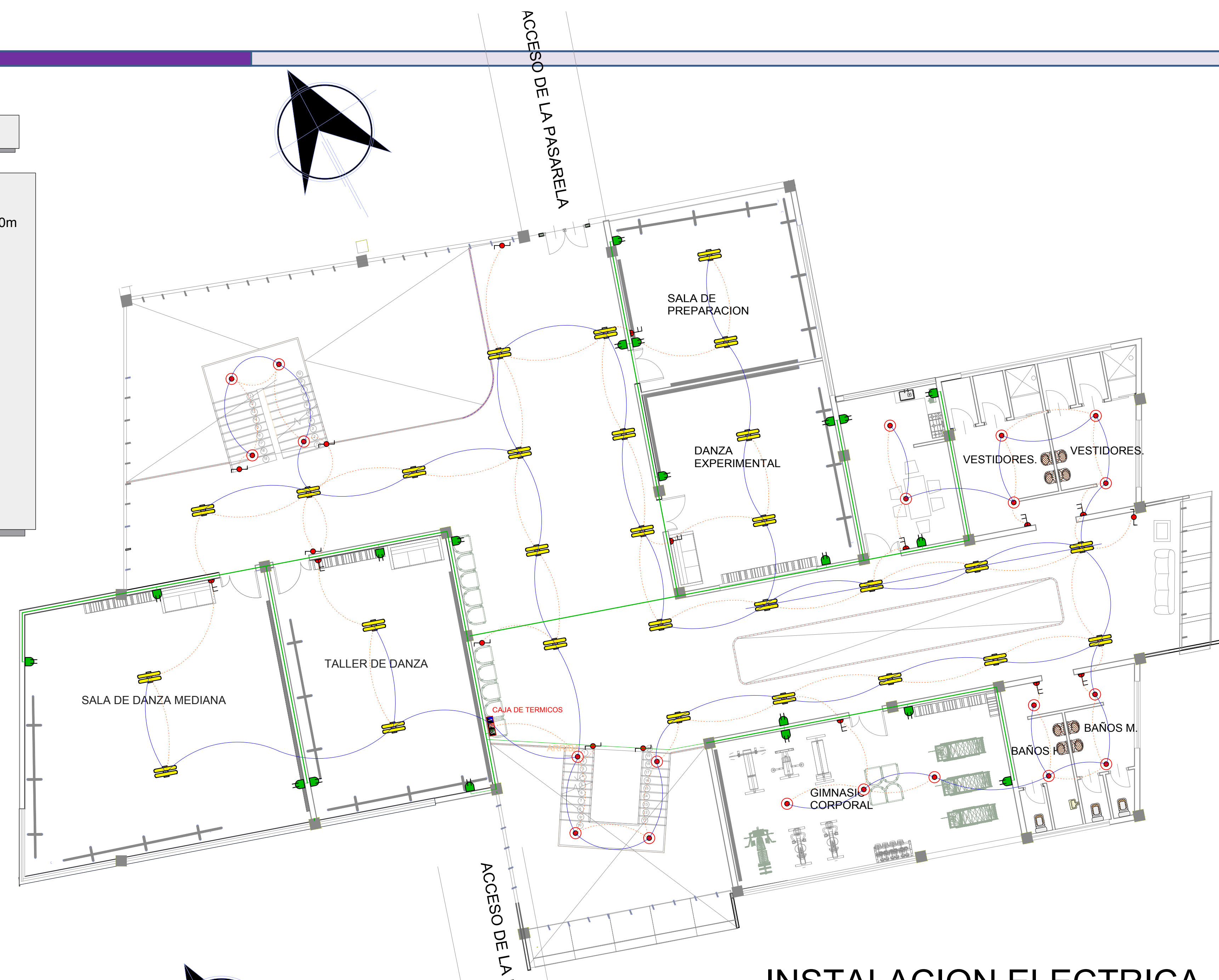
INSTALACION ELECTRICA ESC: 1:100
