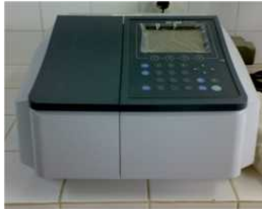
Foto 2-18.- Espectrofotómetro utilizado en la elaboración de la curva patrón de calibración
