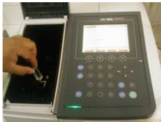
Foto 2-24.- Lectura de la absorbancia en el espectrofotómetro
