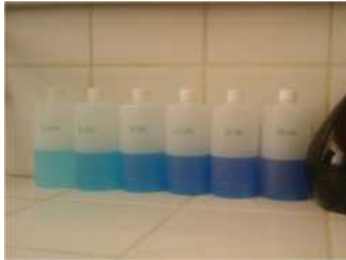
Foto 2-16.- Soluciones de concentración 1, 2, 4, 6, 8 y 10mg/l
