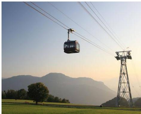
Estos teleféricos desembragables deben su nombre al número de cables que tienen. Una instalación bicable (2S, del alemán) se sostiene sobre un cable portador y un cable tractor. Una instalación tricable (3S) se sostiene sobre un cable tractor y dos cables portadores. Los
