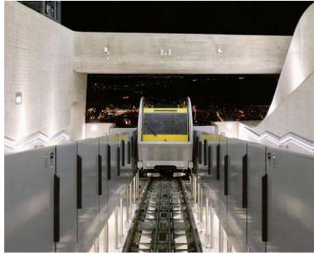
Los funiculares viajan por raíles y se utilizan normalmente para salvar diferencias de altura. La capacidad del vehículo se diseña de forma distinta a los trenes. Los funiculares son los sistemas de transporte por cable más rápidos. Con una velocidad de hasta 14 m/s y la más alta disponibilidad, también se utilizan a menudo como transporte público en las ciudades.<sup>12</sup>
