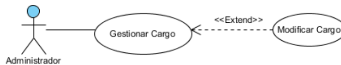
Figura 13 Modelo Diagrama de Caso de Uso Gestionar Cargo
