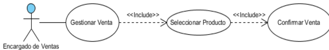
Figura 18 Modelo de Diagrama de Caso de Uso de Gestionar Venta
