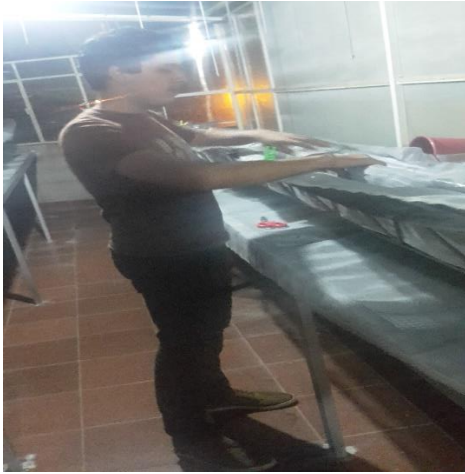
Colocación de Malla Milimétrica a los canales.
