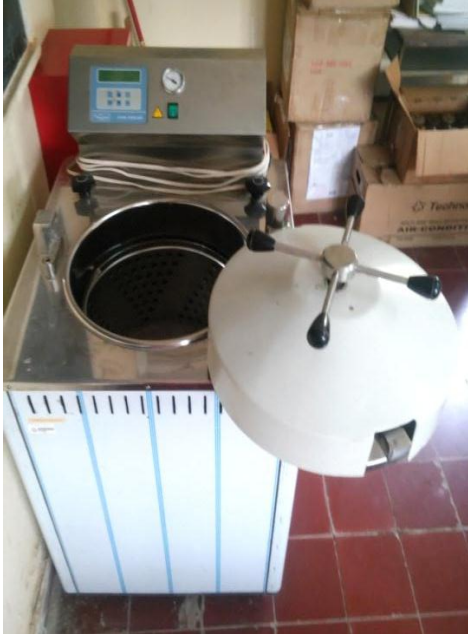
Autoclave Esterilización de Calor Húmedo
