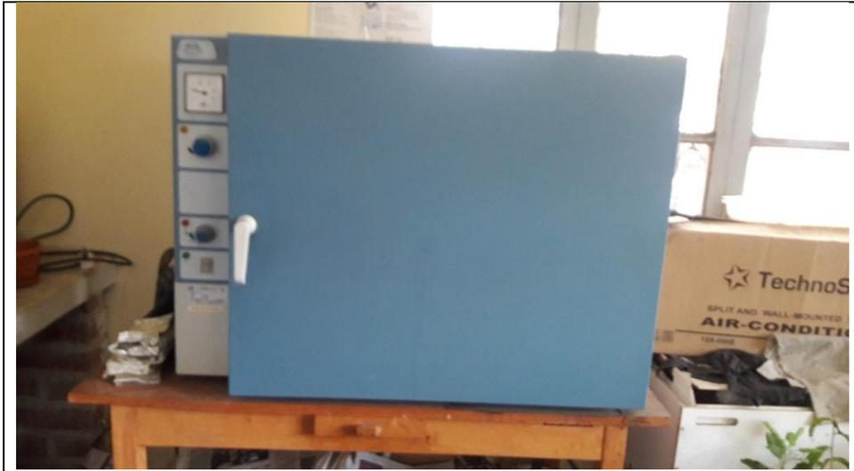
Esterilización de los materiales en calor seco.
