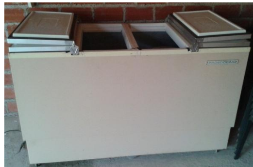
Congelador utilizado para Estabilización por Tratamiento de Frio
