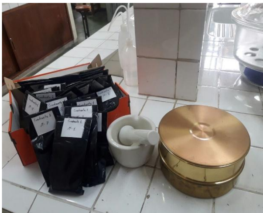
Fotografía N°14: Pulverizado y tamizado de muestras de suelo
