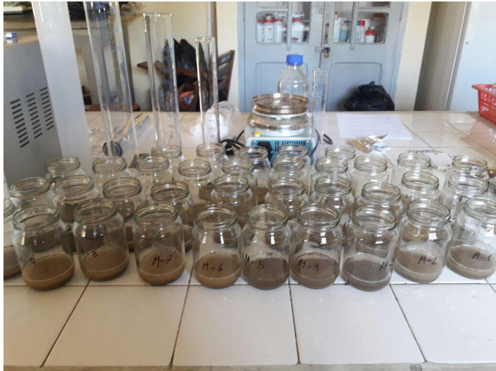
Fotografía N°20: 36 muestras de suelo pesadas y diluidas en 50ml de agua destilada
