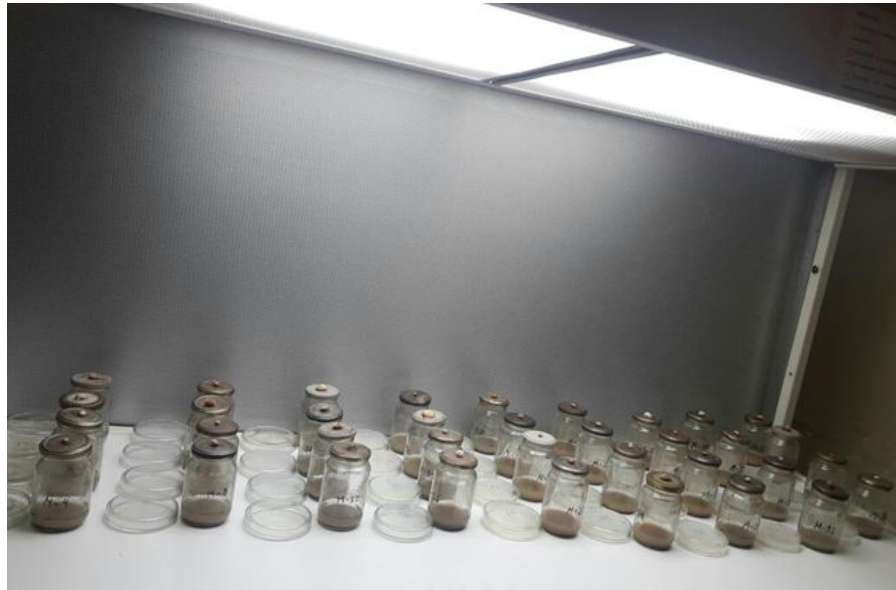
Fotografía N°24: 36 muestras sembradas del suelo dentro de las cajas Petri
