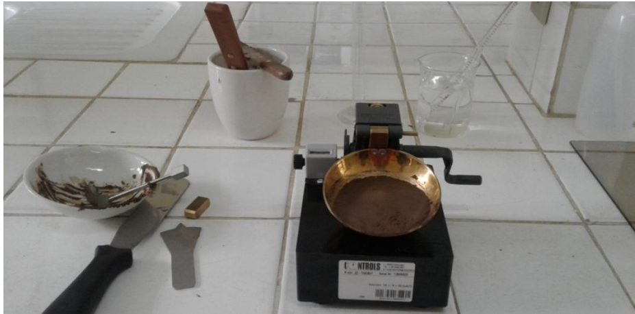
Foto N°23 Material para realizar el límite líquido
