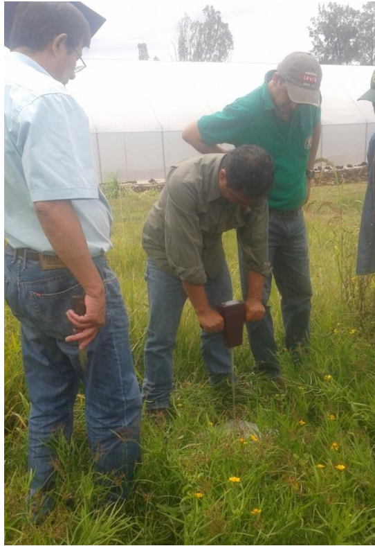
Foto N°10 docentes muestreando con el penetrometro para medir la compactación
