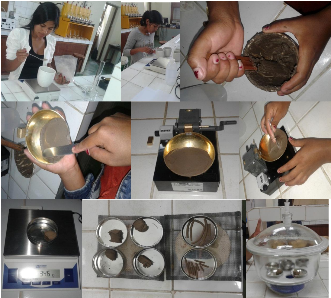
Foto N°23 Material para realizar el límite líquido
