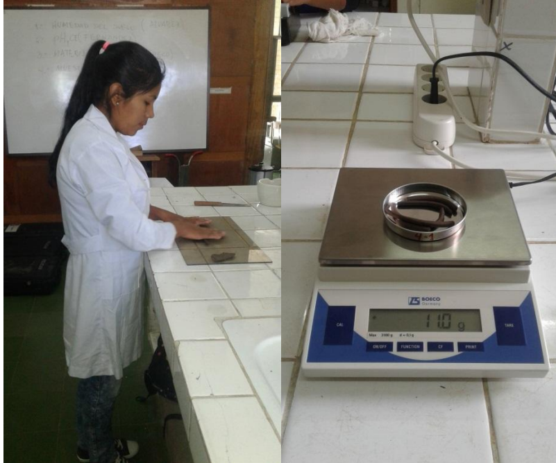
Foto N° 25 Formación y peso de los cilindros para el limite plástico
