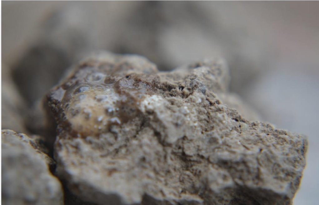
Foto 21: Prueba del ácido clorhídrico para identificación de carbonatos de calcio
