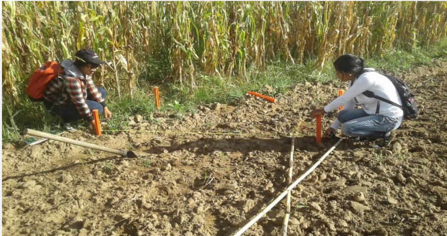
Foto 8: Marcado con estacas para ubicar Calicatas
