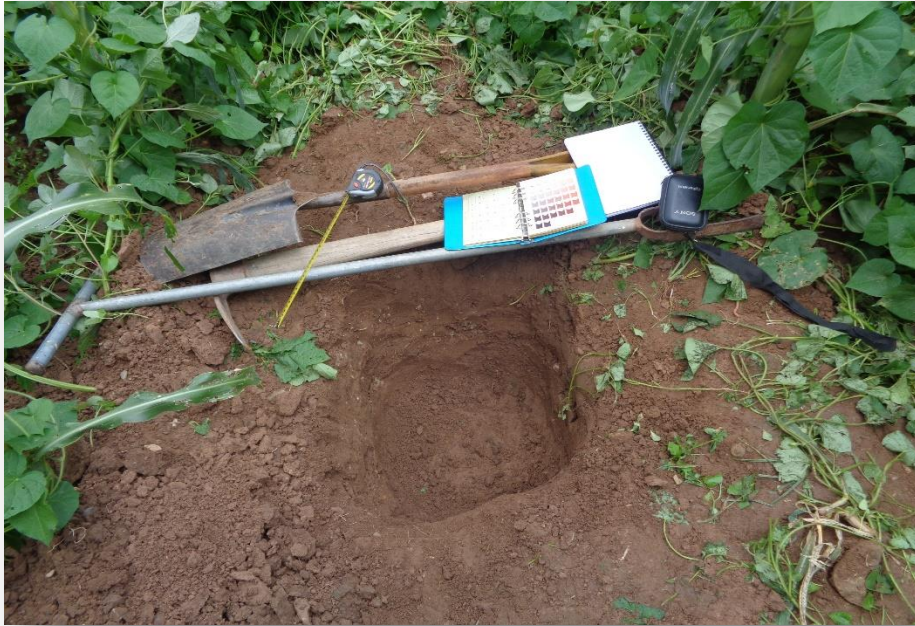
Foto 7: Excavación de microcalicatas
