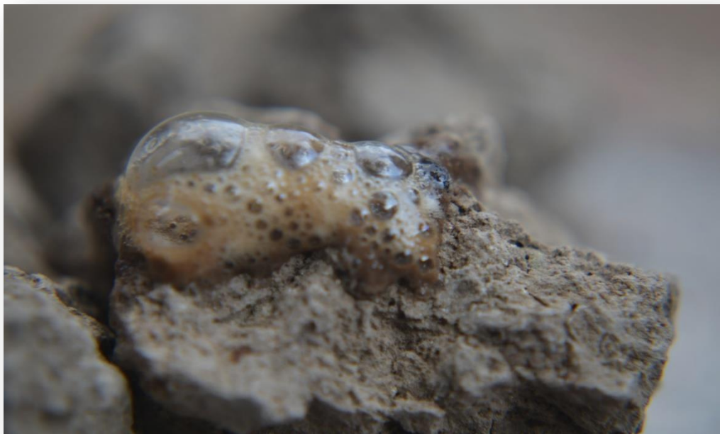
Foto 22: Efervescencia fuertemente visible 20- 30 %
