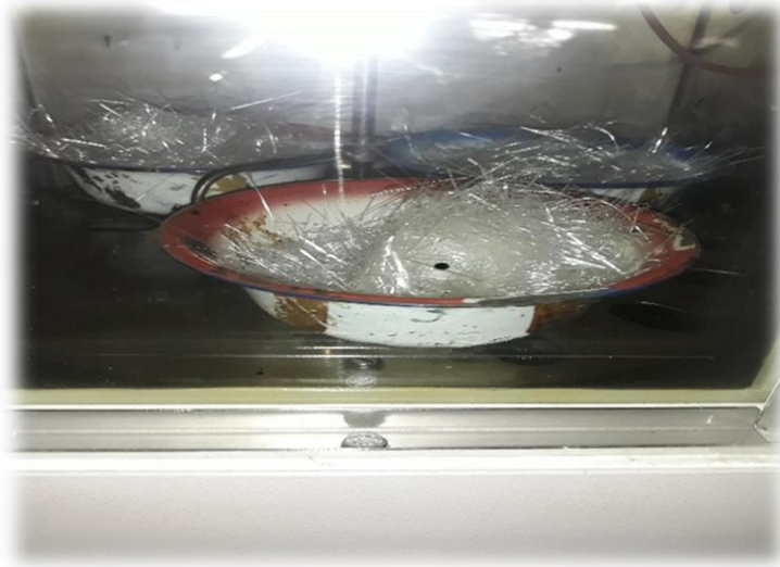
Figura N° 3.15. Fibra de vidrio en interior del horno vista desde el vidrio transparente.
