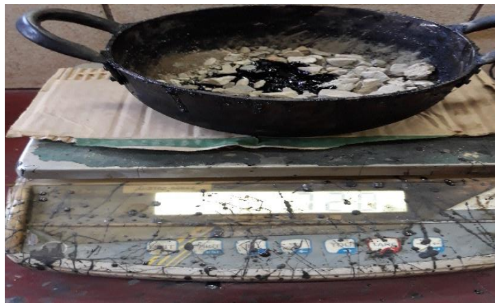
Figura N° 3.21. Agregado de cemento asfáltico a los agregados
