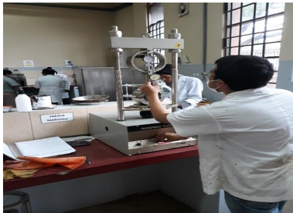
Figura N° 3.28. Lectura de la estabilidad y fluencia equipo Marshall
