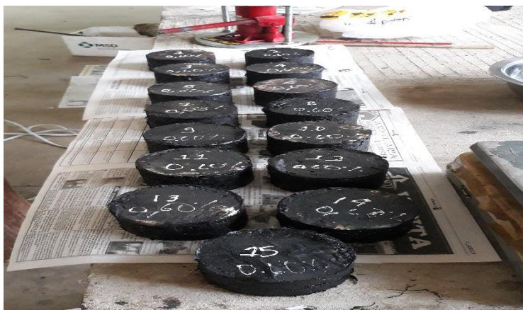
Figura N° 3.44. 15 briquetas con 0.60% de fibra de vidrio para el análisis estadístico.
