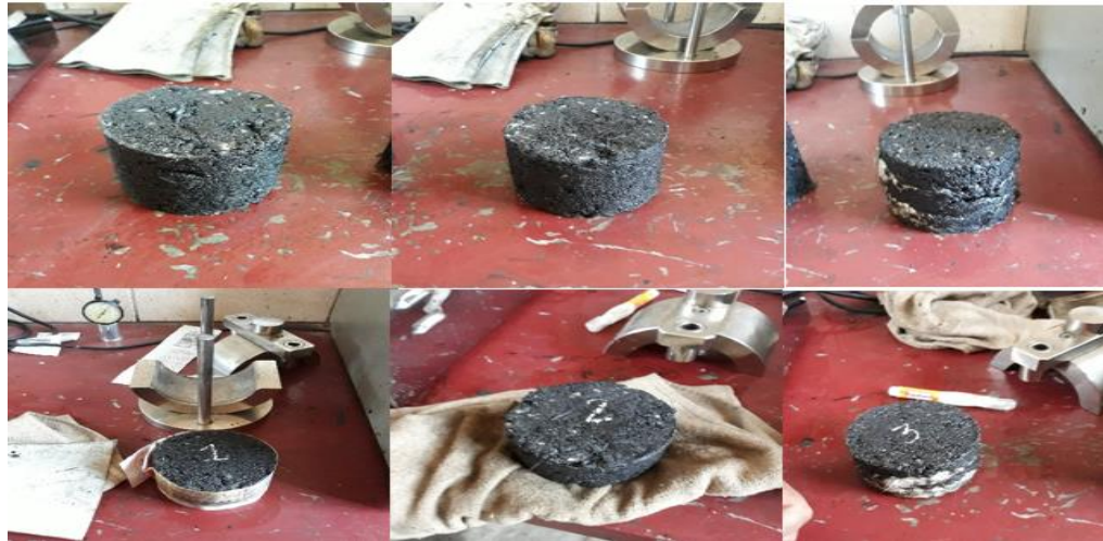
Figura N° 3.33. Briquetas hechas con las tres formas de emplear la fibra de vidrio.
