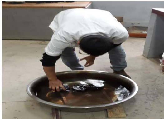
Figura N° 3.27. Baño de agua a 60° C durante 30 minutos.
