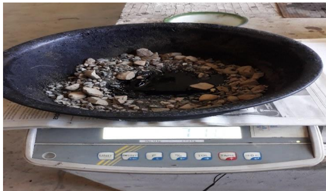
Figura N° 3.45. Mezcla del agregado con el cemento asfáltico.
