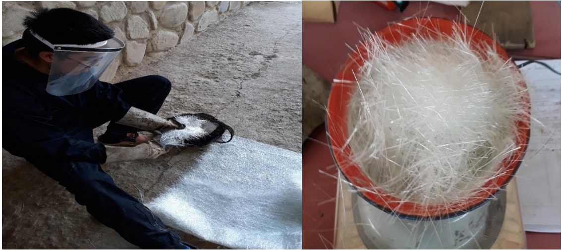
Figura N° 3.29. Fibra de vidrio tipo manta y fibra de vidrio desmenuzada.
