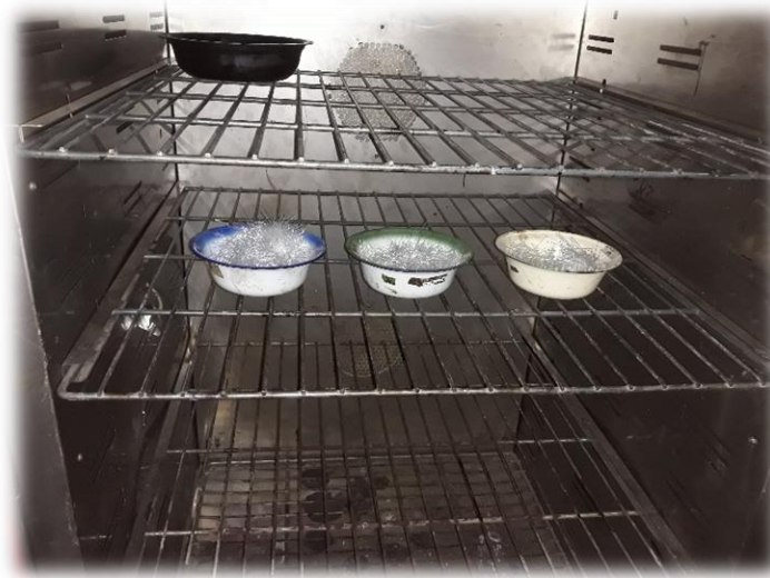
Figura N° 3.17. Material fibra de vidrio en horno más grande la capacidad de temperaturas más altas.
