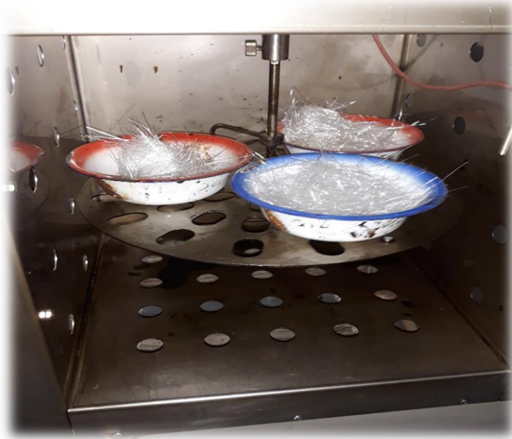
Figura N° 3.14. Material fibra de vidrio en horno giratorio.
