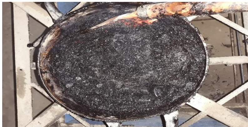
Figura N° 3.30. Mezcla asfáltica con fibra de vidrio.
