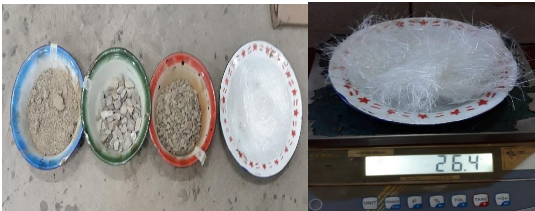
Figura N° 3.34. Pesaje de agregados y la fibra de vidrio.
