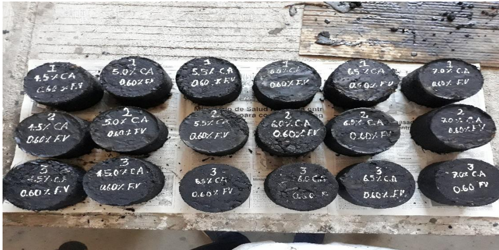
Figura N° 3.47. Muestras compactada en ambas caras.
