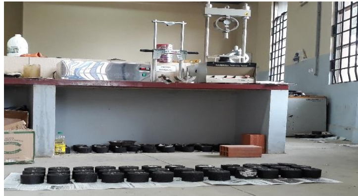
Figura N° 3.42. Briquetas listas para el equipo Marshall
