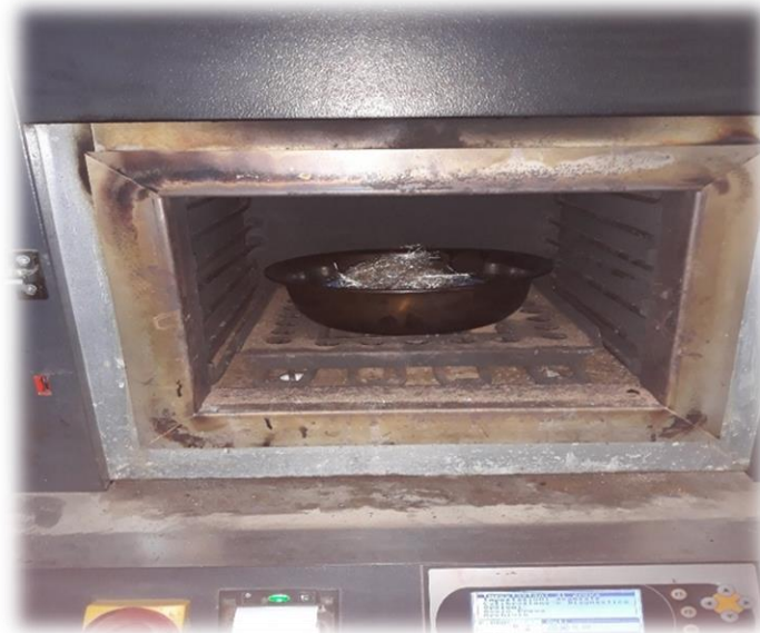
Figura N° 3.20. Material de fibra de vidrio dentro del horno de ignición.
