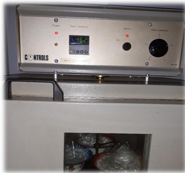
Figura N° 3.16. Fibra de vidrio a una temperatura de 162 °C por un tiempo de 4 horas.
