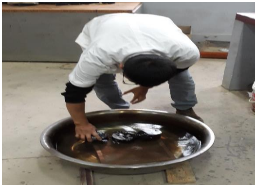
Figura N° 3.27. Baño de agua a 60° C durante 30 minutos.
