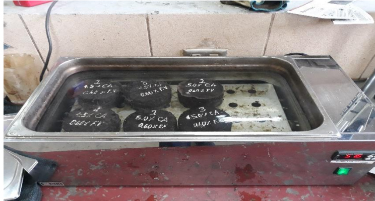
Figura N° 3.49. Baño de agua a 60 ° C durante 30 minutos.
