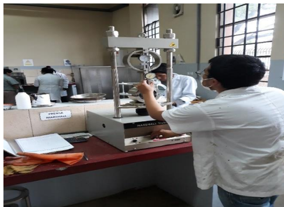
Figura N° 3.50. Lectura de la estabilidad y fluencia equipo Marshall
