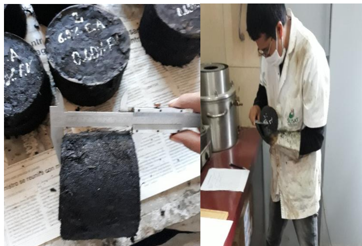
Figura N° 3.48. Medición de alturas de las briquetas.
