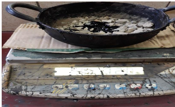
Figura N° 3.21. Agregado de cemento asfáltico a los agregados
