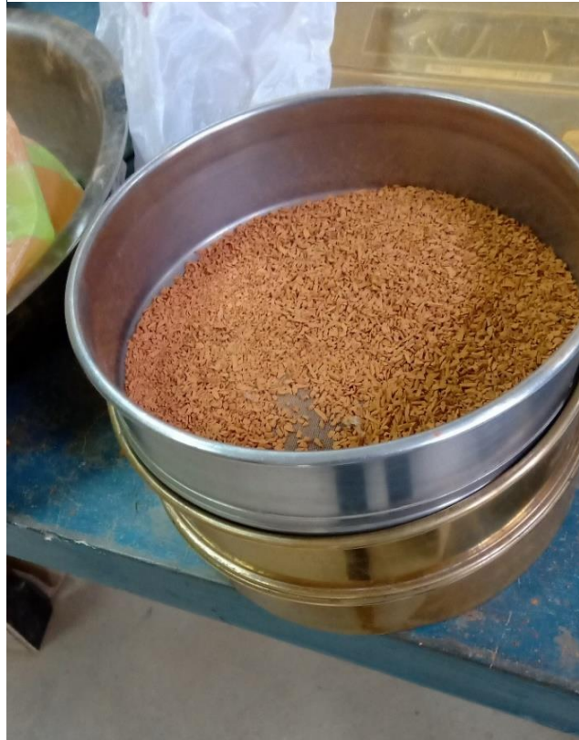
Figura 19. Tamizado del ladrillo triturado
