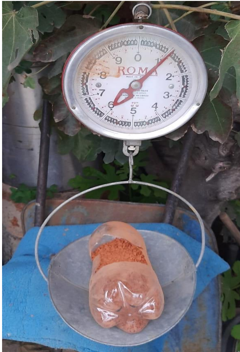
Figura 18. Pesaje del ladrillo triturado
