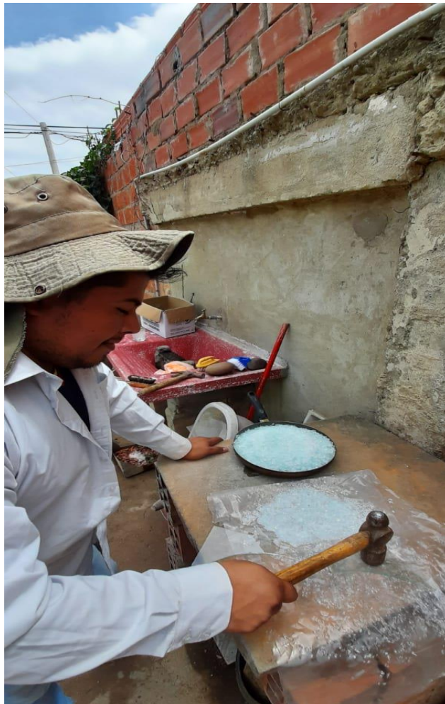
Figura 23. Proceso de molienda del vidrio
