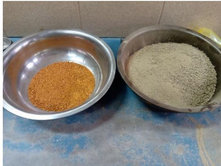
Figura 21. Suelo y ladrillo para compactación
