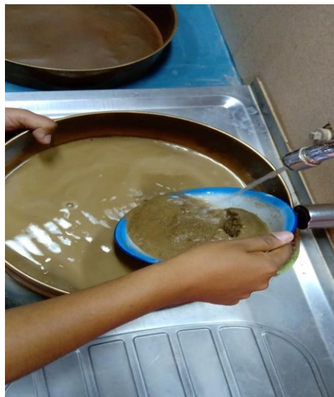
Figura 10. Lavado del suelo fino
