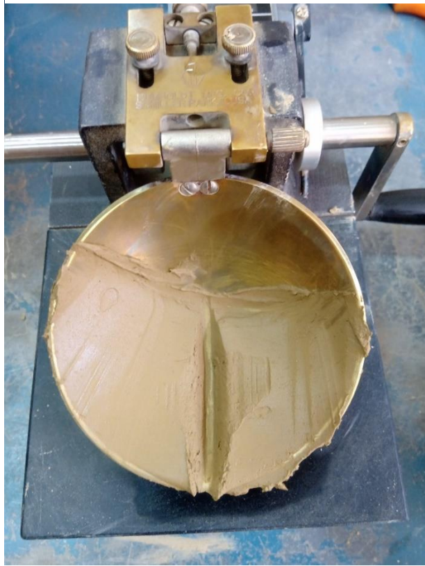
Figura 14. Muestra en el aparato de Casagrande
