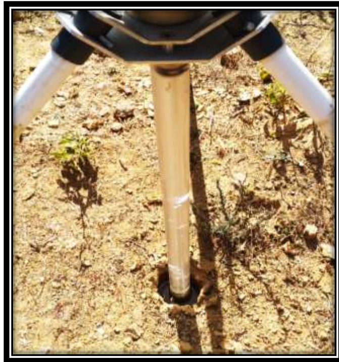
Figura 3.27 Se introduce el cilindro de menor diámetro al orificio Fuente: Elaboración propia
