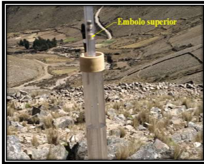
Figura 3.28 Permeámetro de Guelph en funcionamiento Fuente: Elaboración propia
