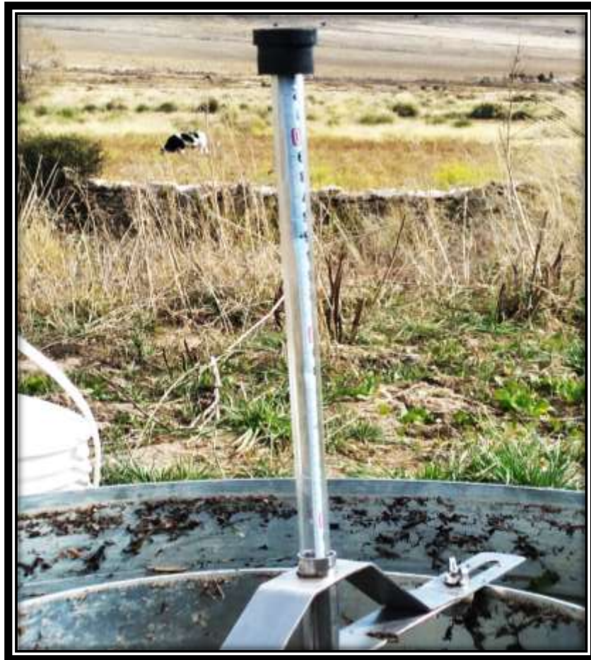
Figura 3.19 Infiltrómetro de doble anillo en la parte baja de la microcuenca Fuente: Elaboración propia
