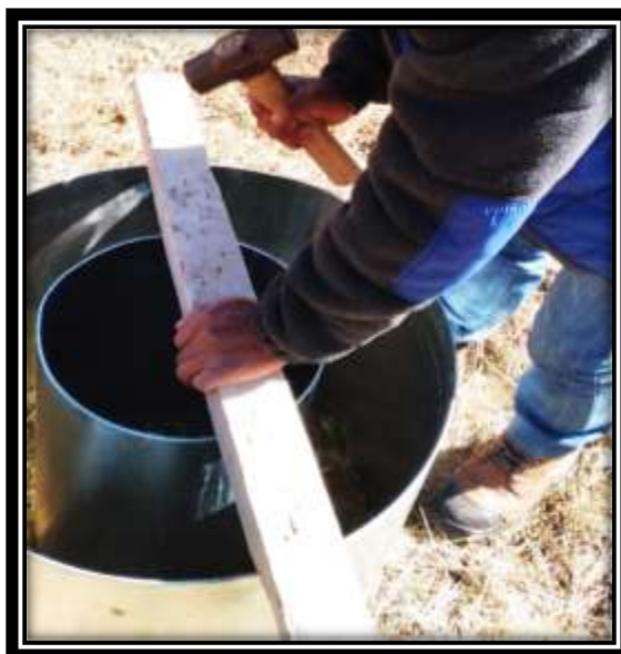
Figura 3.21 Clavado de los anillos en el suelo
