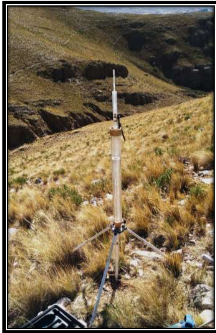
Figura 3.24 Instalación del permeámetro de Guelph en la parte alta de la cuenca Fuente: Elaboración propia
