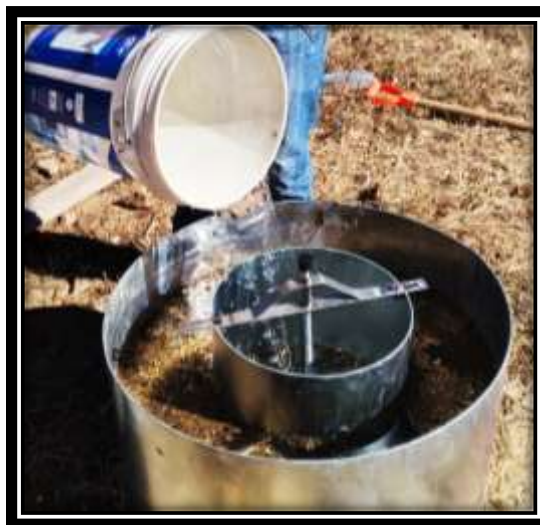
Figura 3.22 Llenado de agua en ambos anillos
