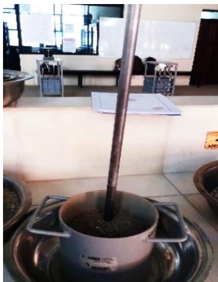
Figura 3.11. Peso unitario de la arena compactada.
