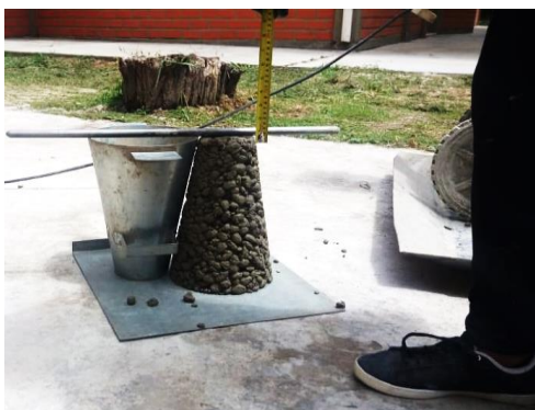
Figura 3.18. Asentamiento mediante el cono de Abram.
