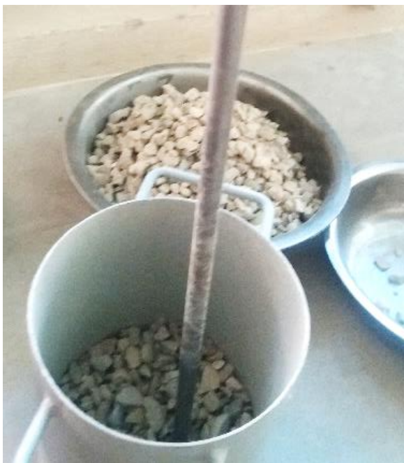
Figura 3.5. Ensayo de peso unitario compactado.
