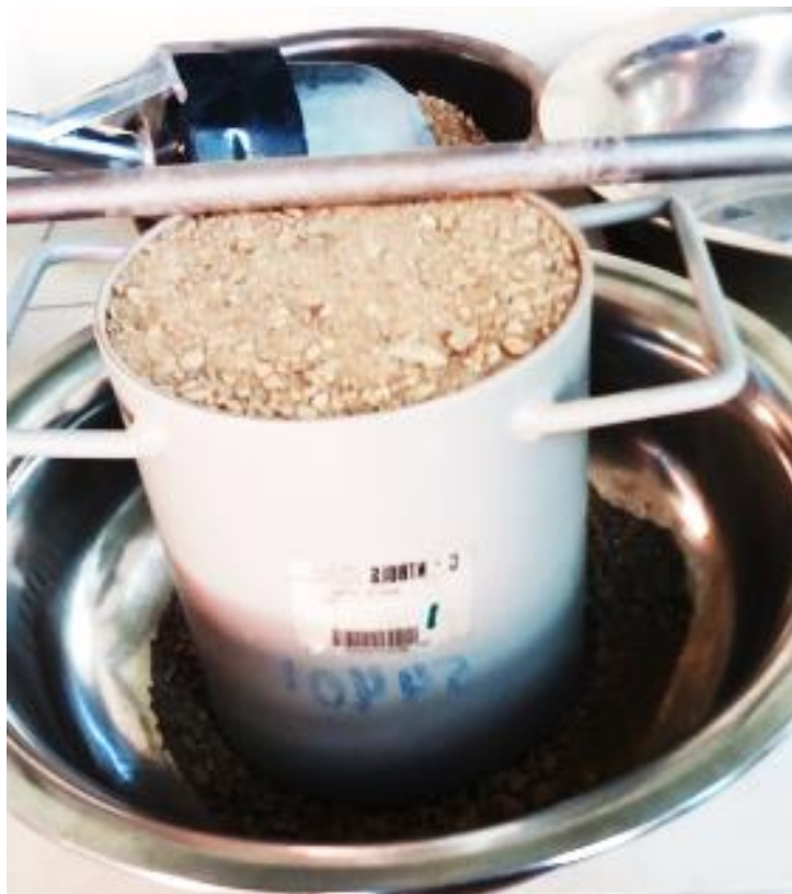
Figura 3.12. Ensayo de peso unitario suelto.
