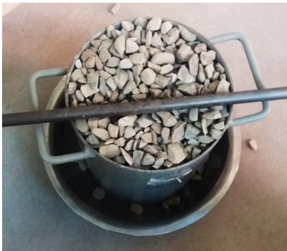
Figura 3.6. Ensayo de peso unitario suelto.
