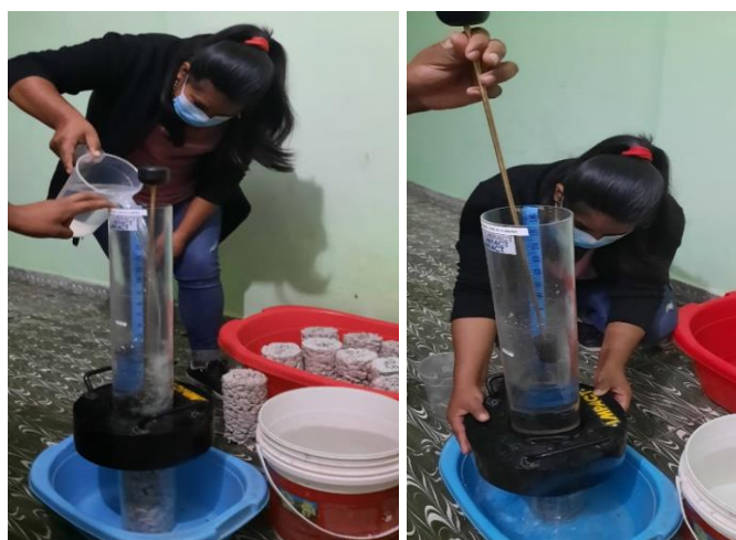
Figura 3.24. Ensayo de permeabilidad.
