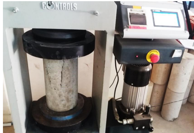
Figura 3.22. Rotura de testigos de hormigón a compresión.
