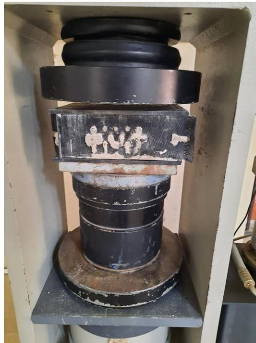
Ensayo a compresión de probetas con geocelda.
