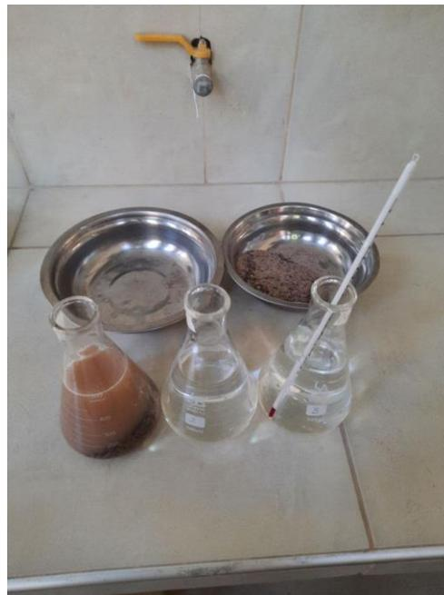
Peso específico y absorción del agregado fino.
