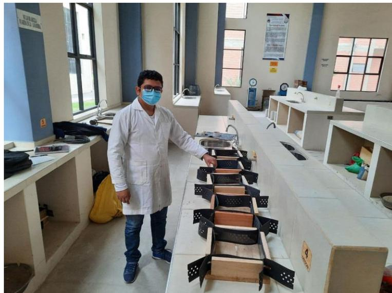
Armado de probetas con geocelda.
