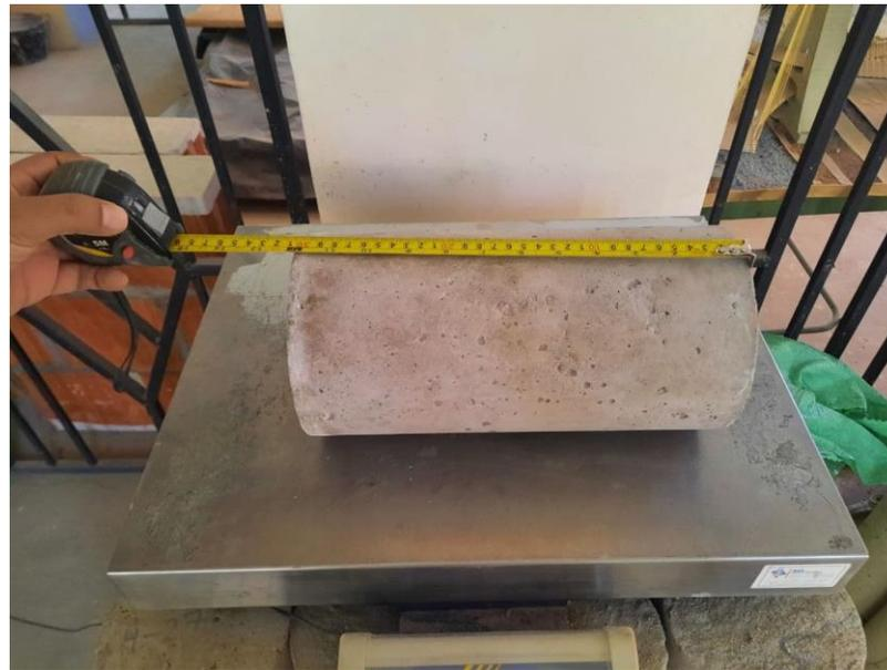
Medición de probetas cilíndricas.
