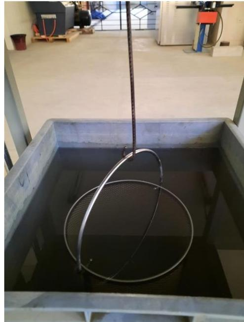
Peso específico y absorción del agregado grueso.
