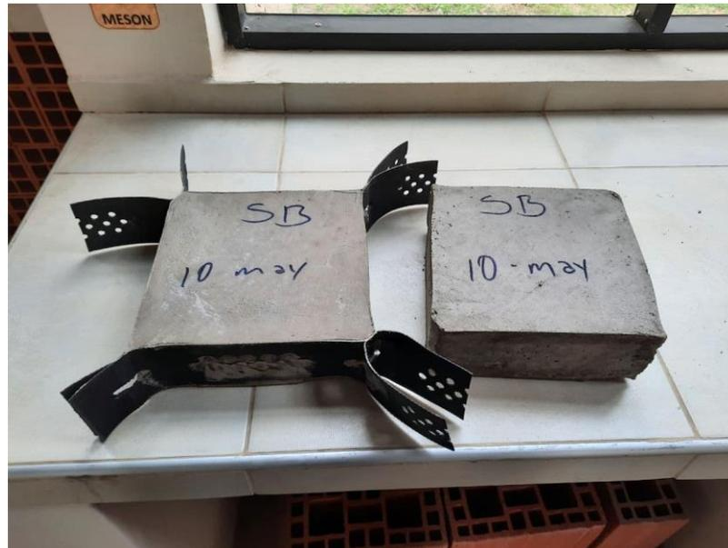
Elaboración de bloques de hormigón con geocelda y sin la misma.
