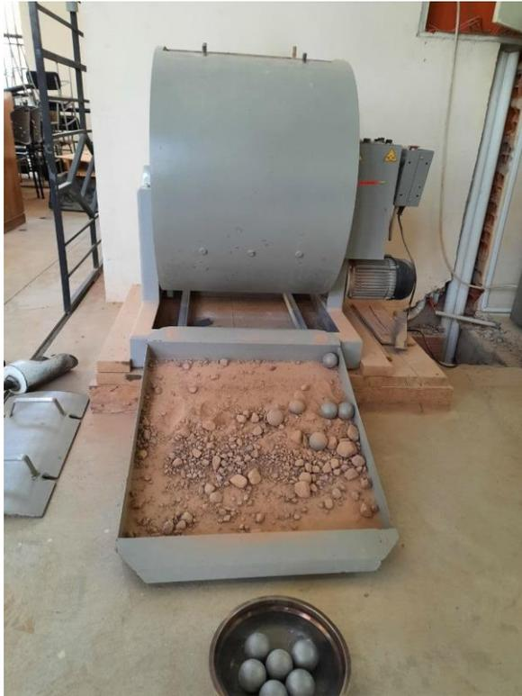
Desgaste mediante la Máquina de Los Ángeles
