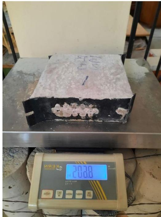
Medición de probetas cúbicas.
