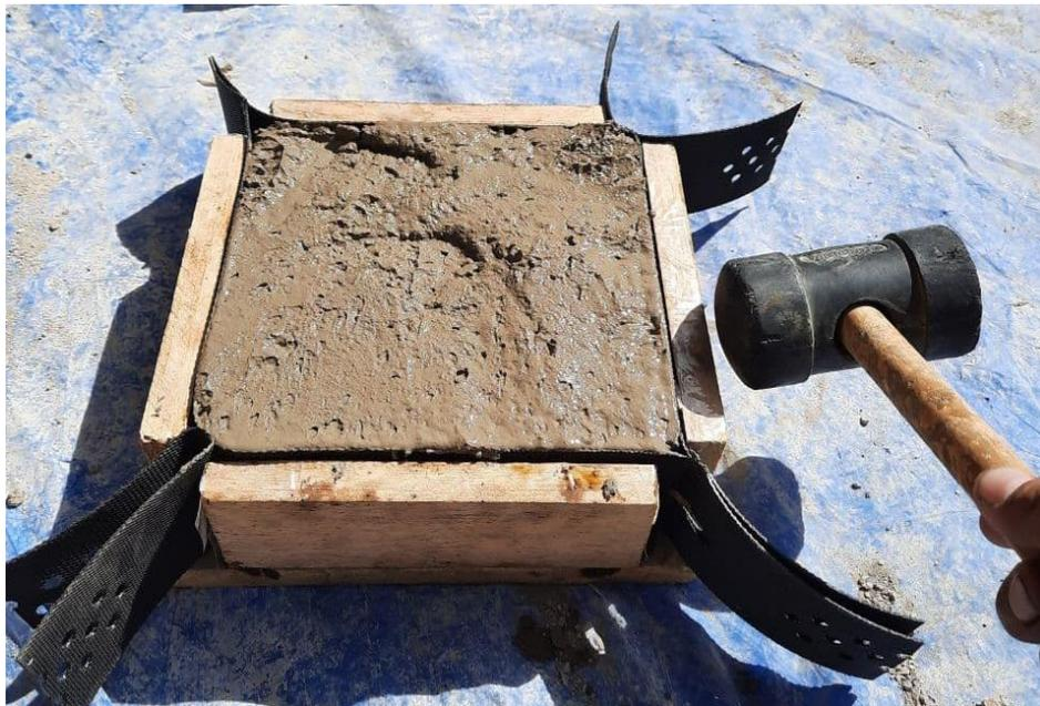
Vertido a probetas con geocelda.
