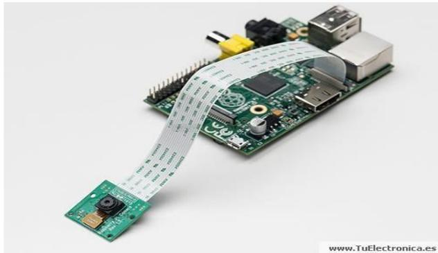
Conexión módulo cámara Raspberry Pi.
