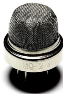
Imagen 20: Sensor de gas y humo MQ2 S32
