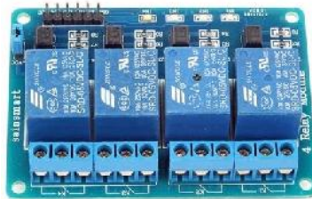
Figura 241: Módulo Relay de 4 canales Modelo MOD-RELE2CH
