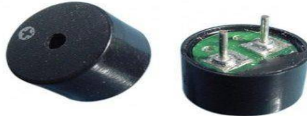
Figura 248: Buzzer Pasivo 5V – Zumbador pasivo
