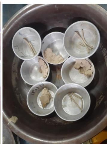
ENSAYO DE PESO ESPECÍFICO
