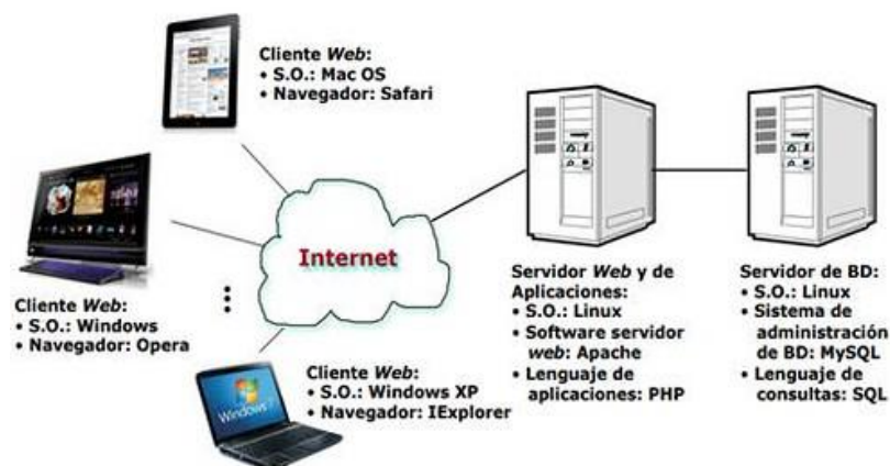
Figura 6. Funcionamiento del modelo cliente servidor
