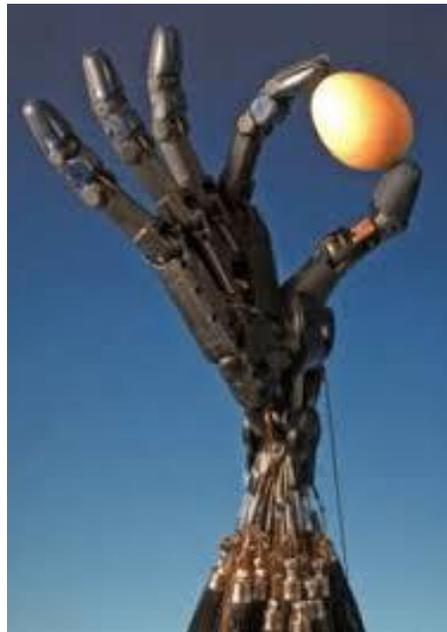
Figura 6. Prótesis neumática shadow.
