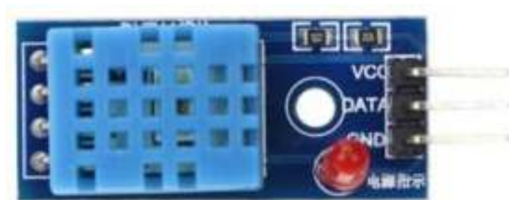
Figura 392: Sensor de temperatura y humedad DHT11
