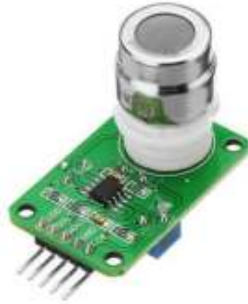
Figura 394: Sensor de medición del dióxido de carbono MG811
