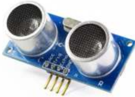
Figura 395: Sensor de distancia ultrasónico HC-SR04
