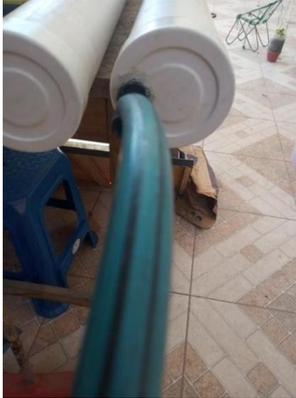
*Figura 86: Conexión de la manguera de salida de riego*
