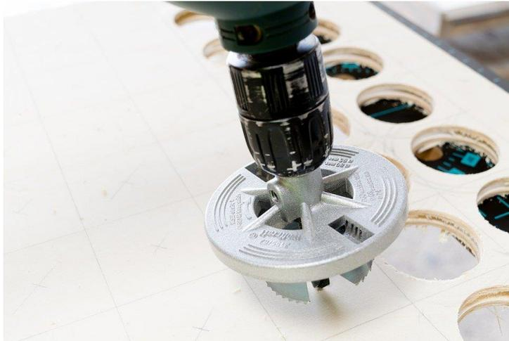
*Figura 67: Sacabocado de 43mm*
