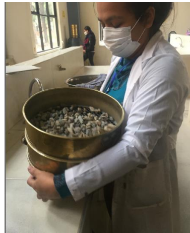
Imagen 1. Cuarteo mecánico y tamizado manual
