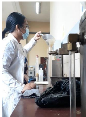
Imagen 7. Equivalente de arena
