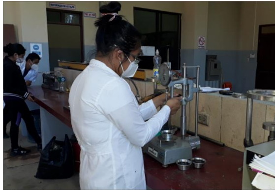
Imagen 8. Ensayo de penetración
