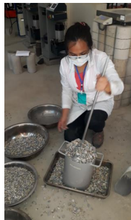
Imagen 2. Compactado de material con varilla metálica
