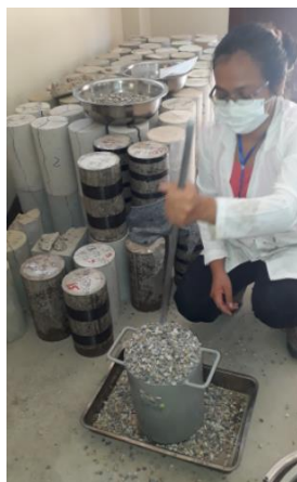
Imagen 2. Compactado de material con varilla metálica
