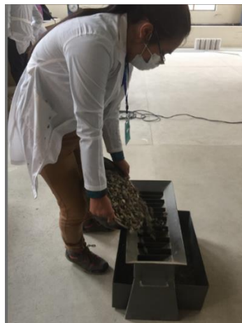
Imagen 1. Cuarteo mecánico y tamizado manual
