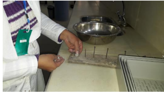
Imagen 6. Índice de alargamiento y aplanamiento
