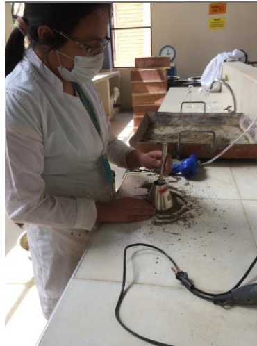
Imagen 4. Muestra saturada superficialmente seca
