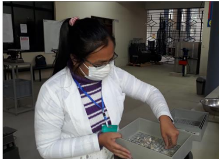
Imagen 6. Índice de alargamiento y aplanamiento
