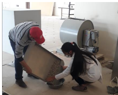
Imagen 5. Ensayo de abrasión – máquina de los ángeles
