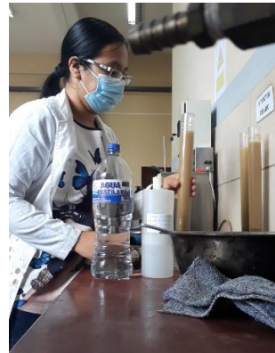
Imagen 7. Equivalente de arena
