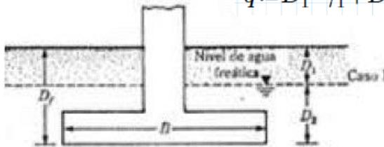
Ecuación de la capacidad portante en condiciones No drenadas
