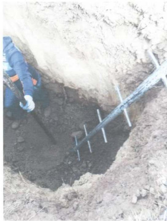
Preparación del equipo para ejecutar el ensayo correspondiente al sondeo S-01
