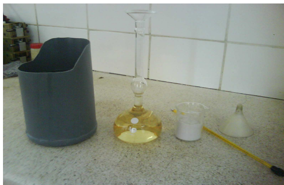
Figura 4.9. Ensayo de Peso específico
