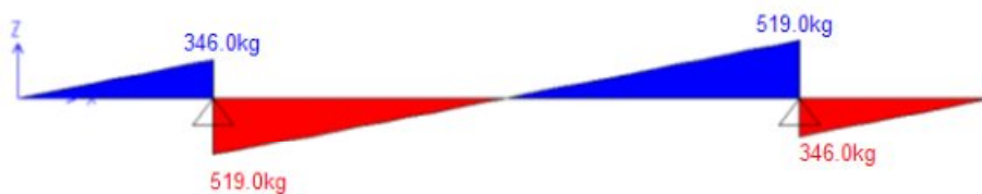
Fig.50 diagrama de cortantes debido al peso propio
