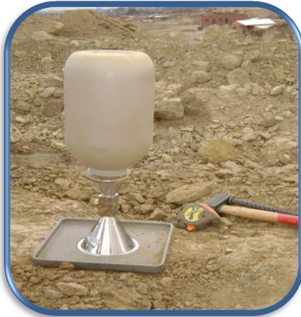
Figura64-Cono de arena con válvula abierta 48
