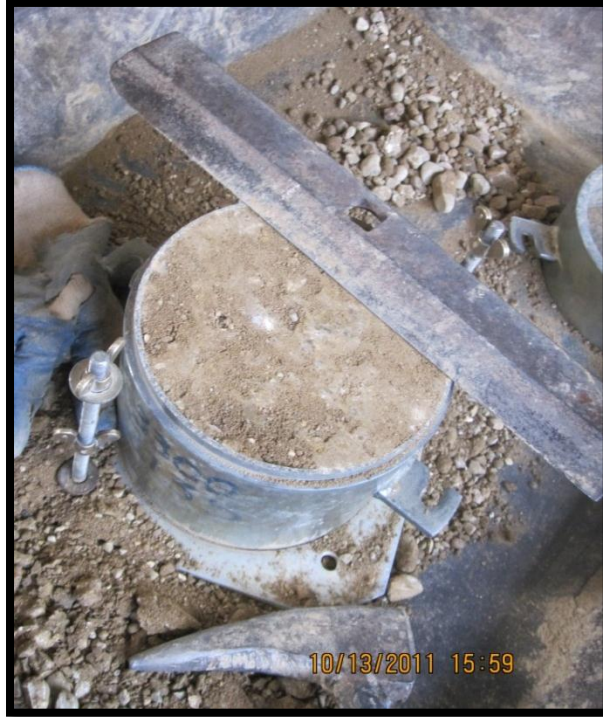
ENRASADO DEL MOLDE DE COMPACTACION T-180.
