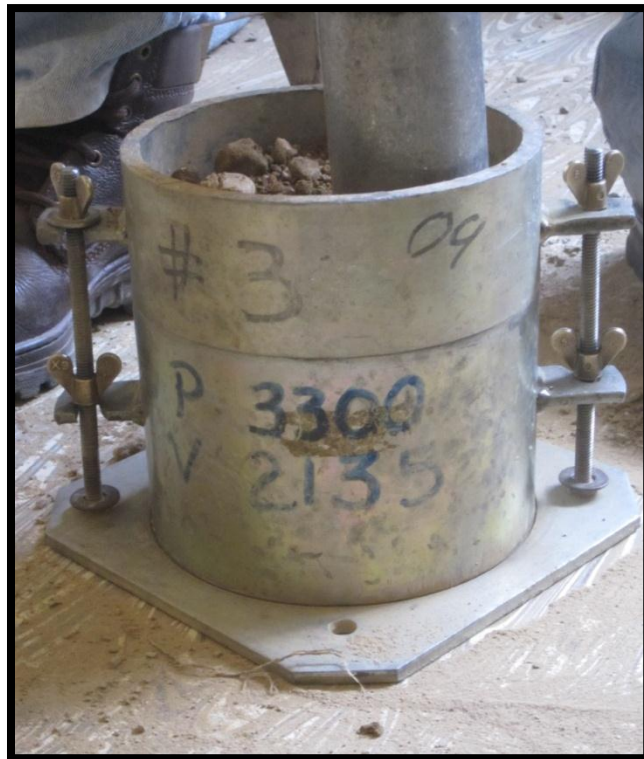
REALIZACION DEL ENSAYO DE COMPACTACION PROCTOR T-180.
