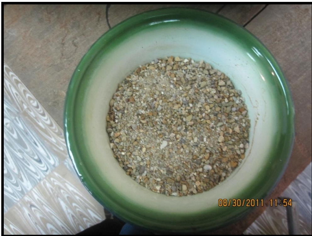
TARA CON PESO SECO PARA LA REALIZACION DEL ENSAYO GRANULOMETRICO.
