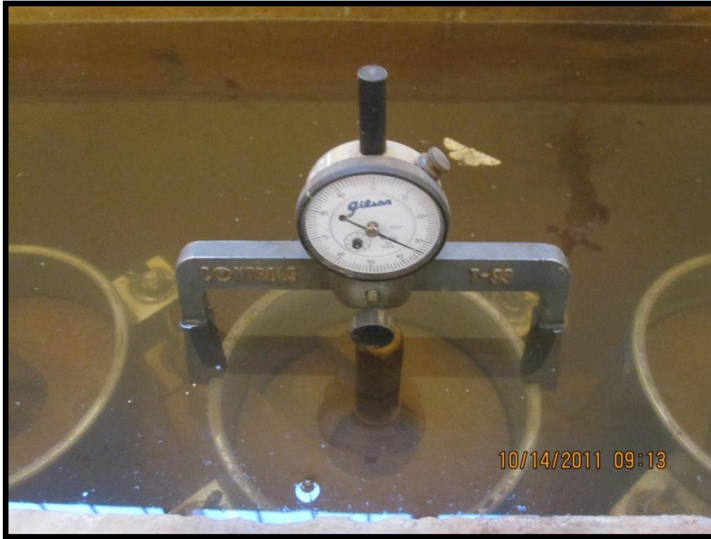
LECTURA DE LA EXPANSION CON EL EXTENSOMETRO.
