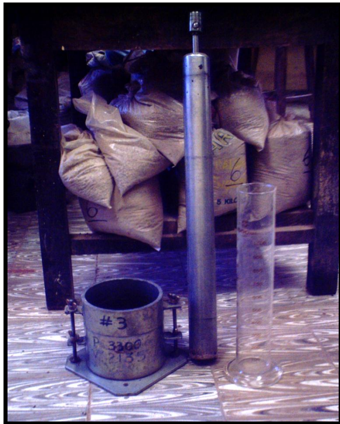
EQUIPO PARA LA REALIZACION DEL ENSAYO DE COMPACTACION T-180.
