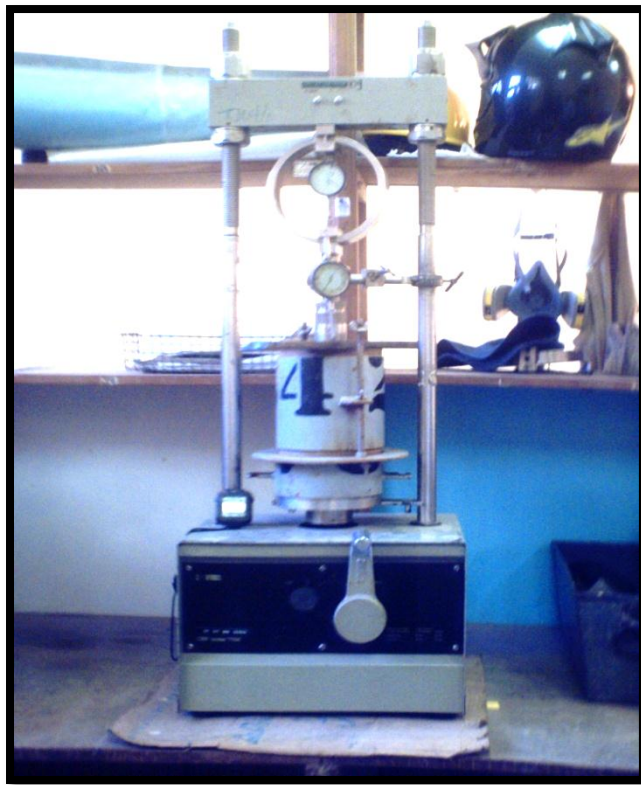
EQUIPO PARA REALIZAR EL ENSAYO DE CBR.
