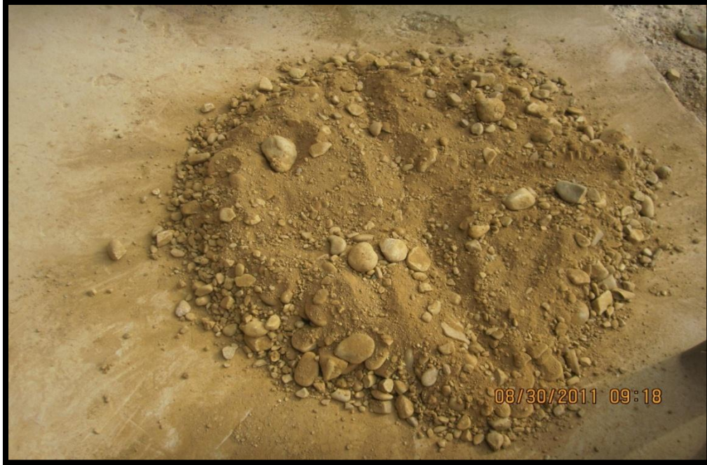
CUARTEO DEL MATERIAL DE SUB-BASE.
