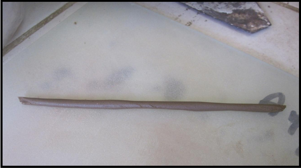
REALIZACION DEL ENSAYO DE LIMITE PLASTICO.
