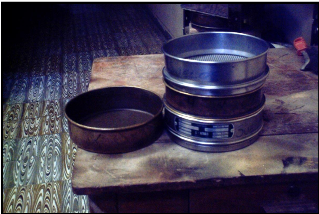
JUEGO DE TAMICES PARA ENSAYO GRANULOMETRICO PARTE FINA.
