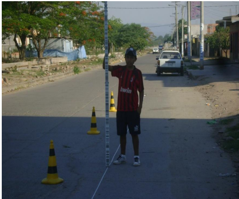
Fig. 3.8. Procedimiento de medición de datos para la determinación del IRI
