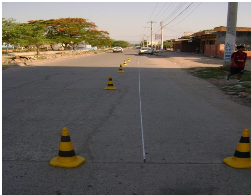
Fig. 3.7. Procedimiento de medición de fallas superficiales
