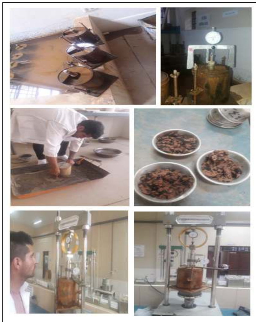
Figura 22. Proceso de inmersión y penetración del ensayo de CBR
