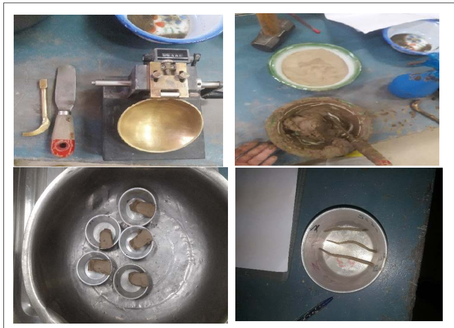
Figura 20. Realización del ensayo de límites de Atterberg
