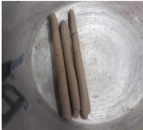
Figura 3.16 Rollitos de muestra fina para determinar el límite plástico laboratorio de suelos UAJMS
