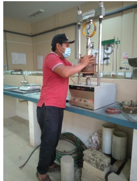
Figura 3.18 Ensayo de C.B.R. en laboratorio de suelos UAJMS
