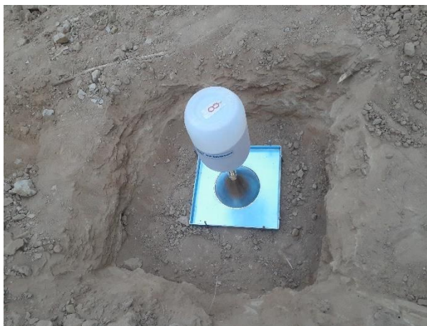
Figura 3.12 Ensayo de densidad in situ método cono de arena
