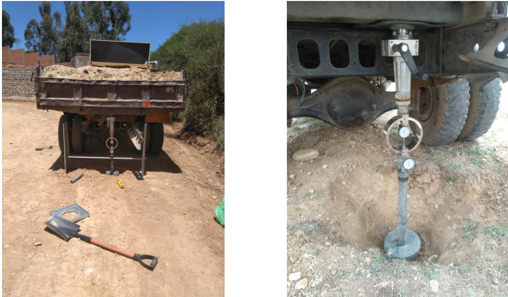
Figura 3.20 Ensayo de C.B.R. in situ Barrio Aranjuez
