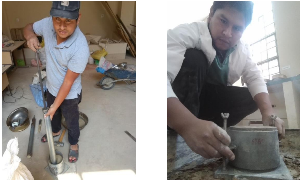
Figura 3.17 ensayo de compactación laboratorio de suelos UAJMS
