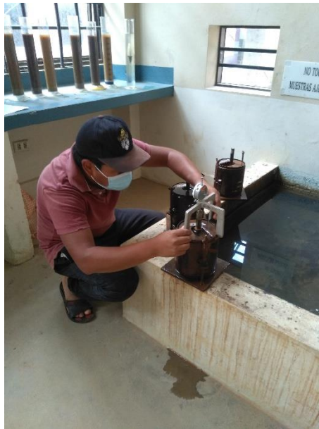
Figura 3.18 Ensayo de C.B.R. en laboratorio de suelos UAJMS
