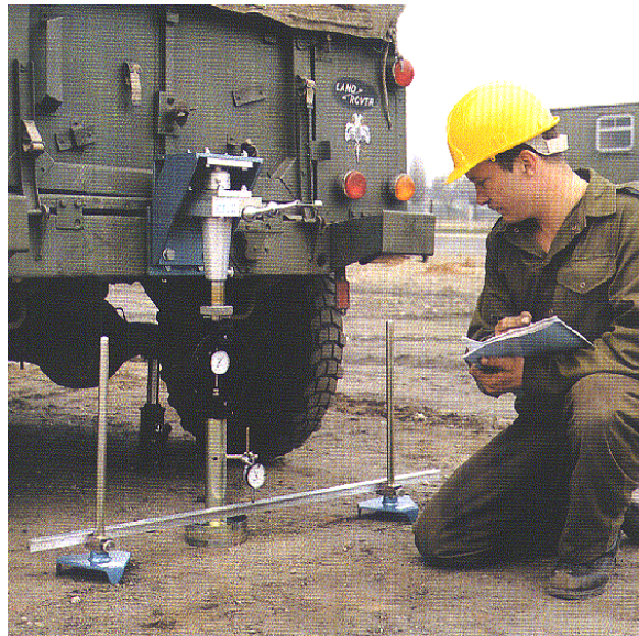
Figura 2.33 Ensayo C.B.R. in situ.
