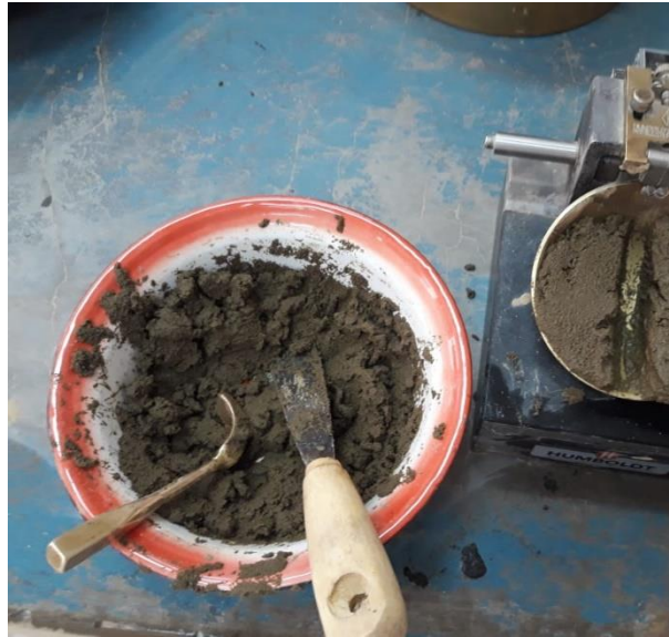
Figura 3.15 Determinar el límite líquido en laboratorio UAJMS
