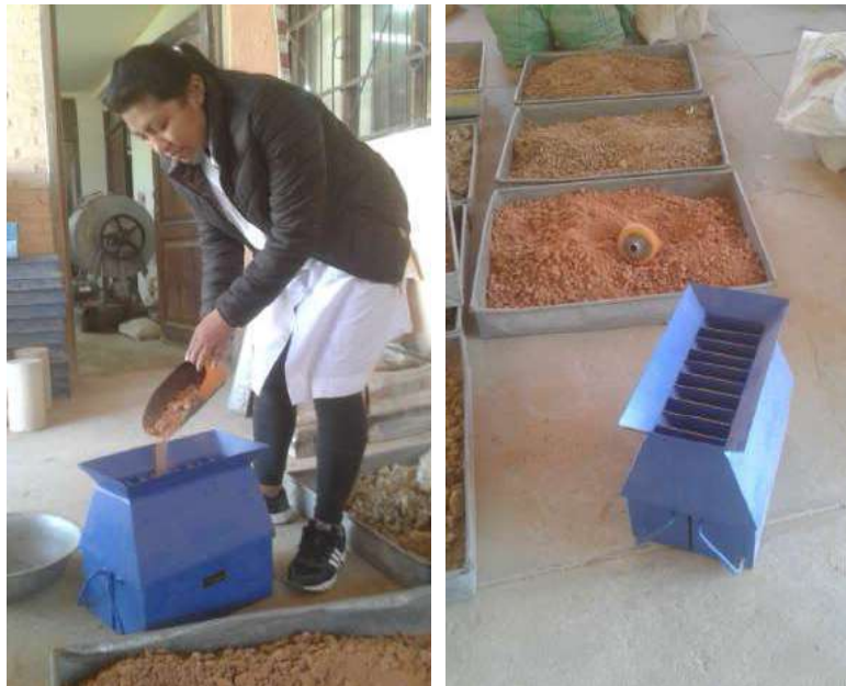
Figura 3.8 - Cuarteador de muestras sólidas
