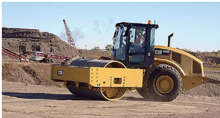
Figura 2.19 – Estabilización mecánica (Compactación)
