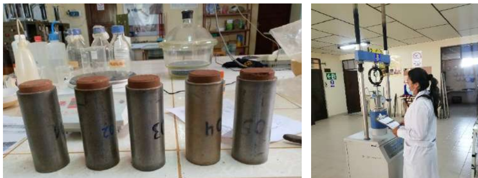
Figura 3.32 – Toma de lecturas del ensayo Mini-CBR y su expansión
