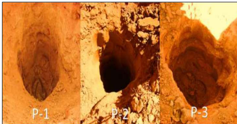
Figura 3.6 – Excavación de los puntos de extracción de muestras
