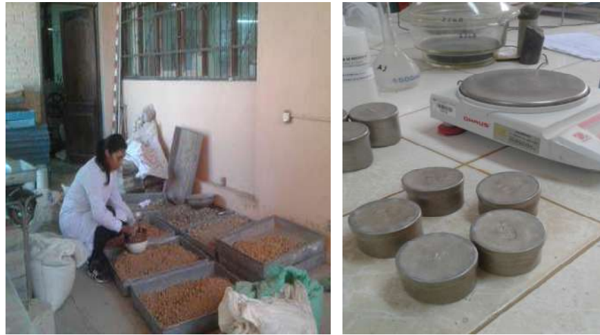
Figura 3.9 - Tamizado y secado de muestra en horno
