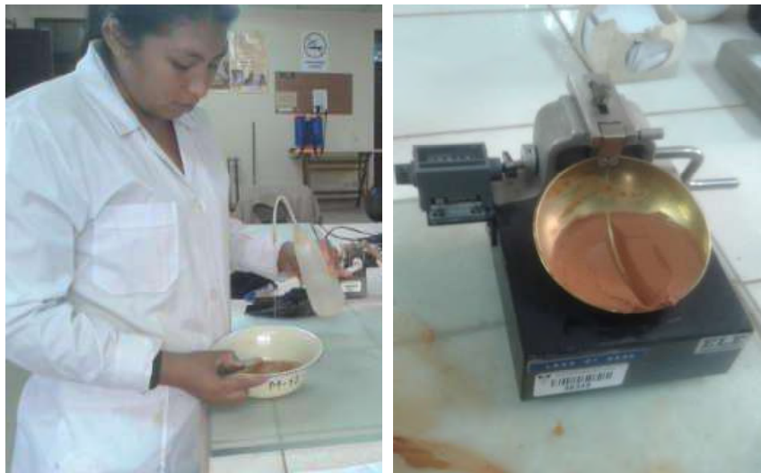
Figura 3.12 - Ensayo Con utilización del equipo Casagrande
