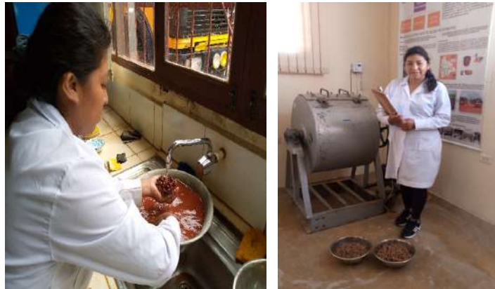
Figura 3.15 - Ensayo de Abrasión de los Angeles
