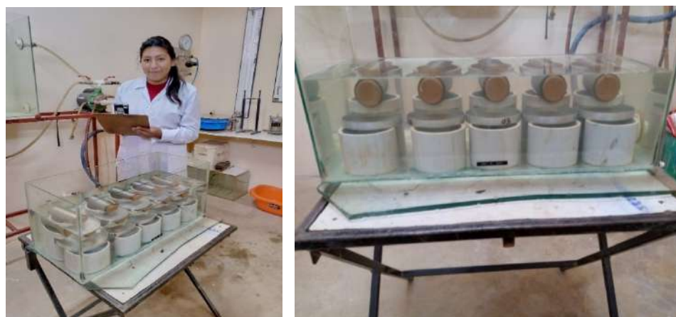
Figura 3.22 – Sumersión para clasificación MTC
