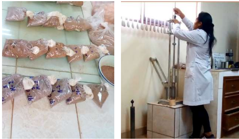
Figura 3.24 – Preparación muestras y equipo Mini-Proctor
