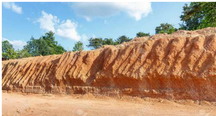
Figura 2.1 – Sección transversal suelo laterítico
