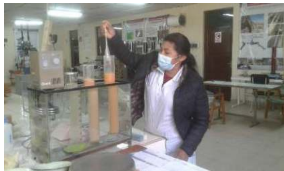
Ensayo de Hidrometría.
