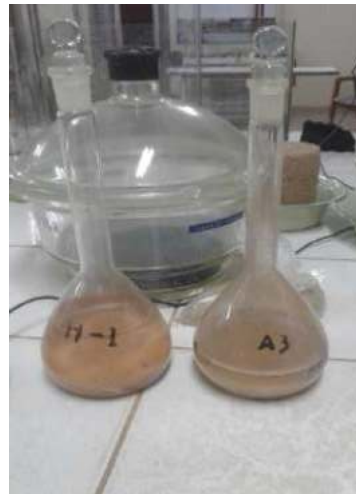
Extracción de vacíos del suelo para Determinar su peso específico.
