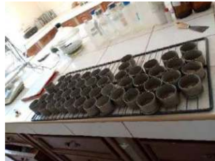
Ensayo para determinar el límite plástico.
