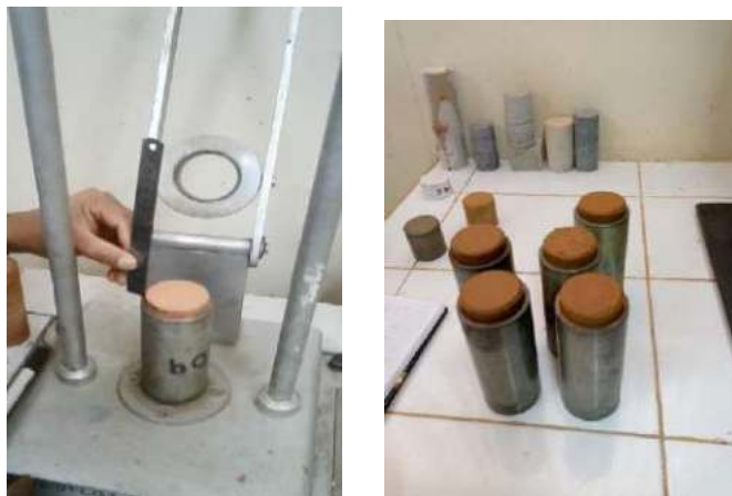
Extracción de 10mm del espécimen después de la compactación durante el ensayo Mini-MCV
