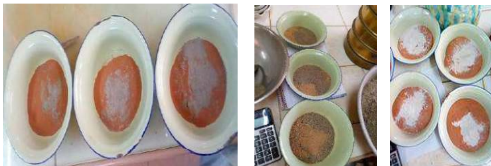
Estabilizados con porcentajes de Cal, Cemento y Aluvial (3%,6% y 9%).
