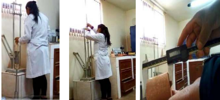
Compactación por el ensayo Mini Proctor con energía intermedia.
