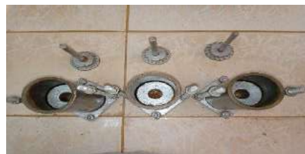
Lectura de las alturas iniciales de los suelos para determinar sus expansiones en el ensayo Mini- CBR.
