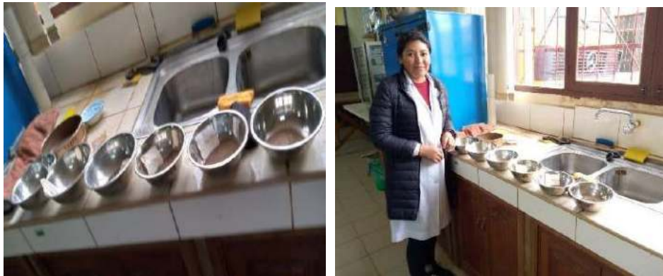
Figura 1 – Realización del ensayo sulfato de sodio
