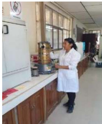
Ensayo granulométrico por tamizado del suelo.
