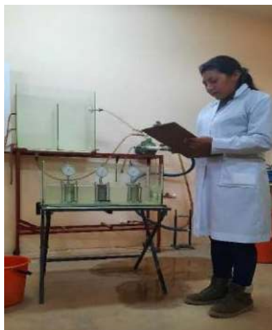
Lectura de las alturas iniciales de los suelos para determinar sus expansiones en el ensayo Mini- CBR.
