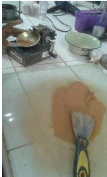
Ensayo para determinar el límite plástico.
