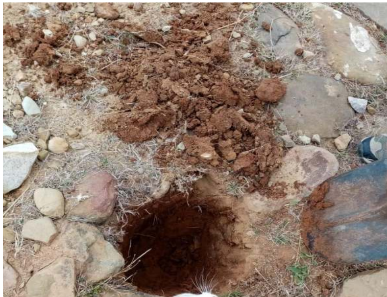
Fotografía 4 Extracción de muestra de suelo presa Colpana
