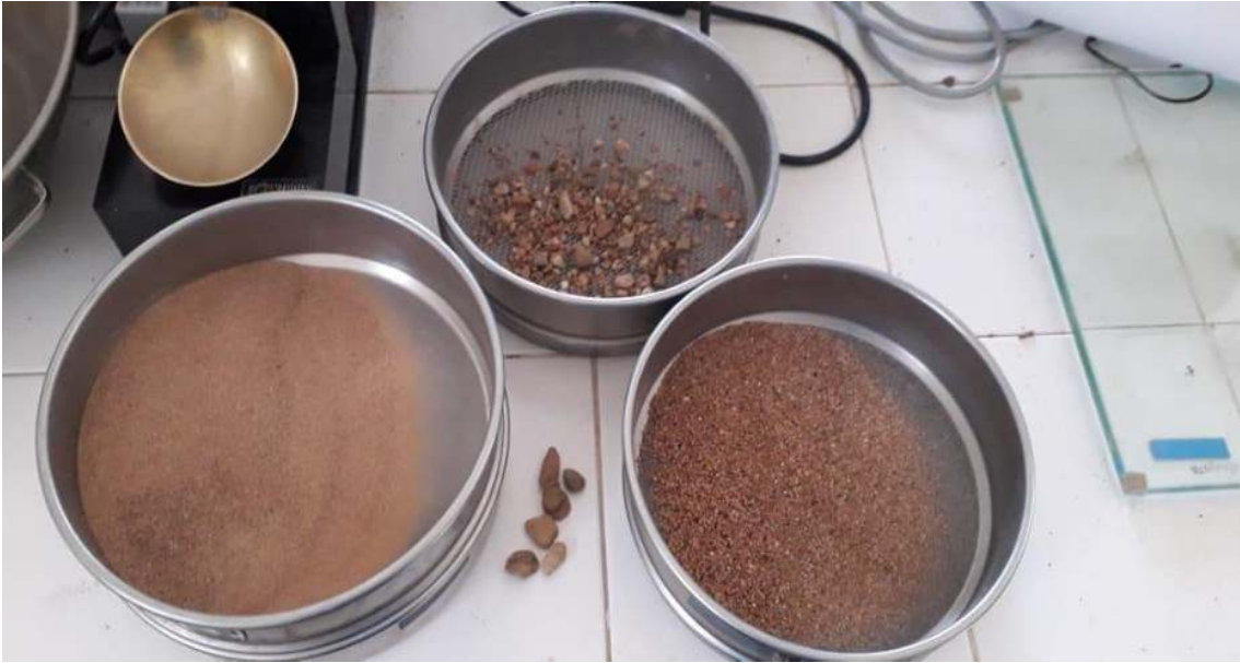
Fotografía 7 Ensayo de Granulometría
