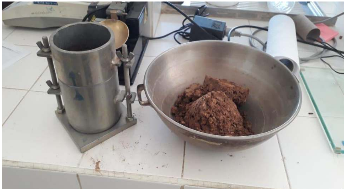
Fotografía 12 Ensayo Compactación T180
