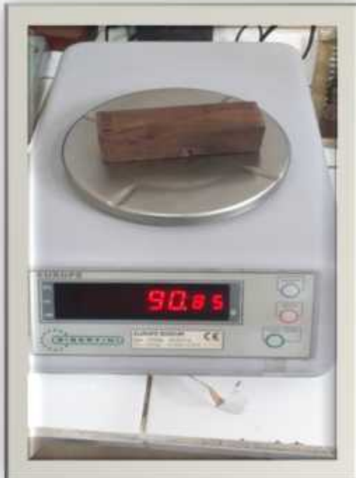
Pesaje de las probetas
