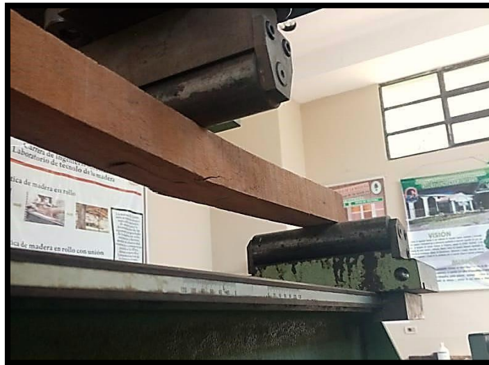
Figura 4.6: Momento del fallo en probeta sin refuerzo Fuente: Elaboración propia
