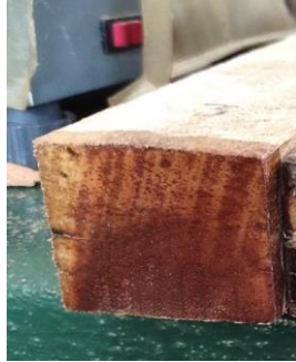
Figura 3.4: Sellado de probetas Fuente: Elaboración propia.
