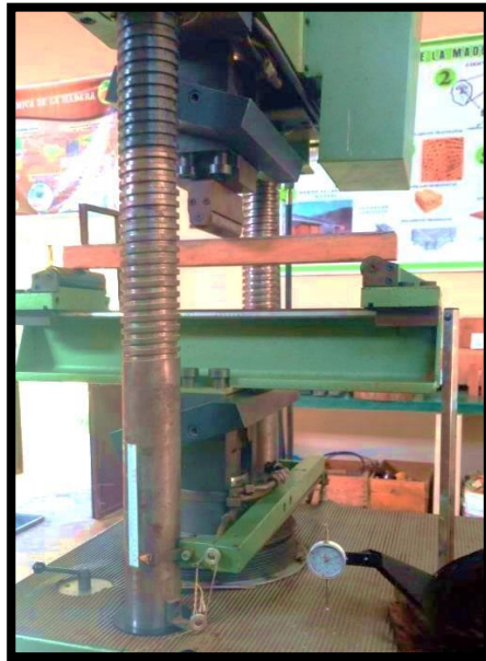
Figura 3.6: Prueba a flexión estática en probetas simplemente apoyadas. Fuente: Elaboración propia.
