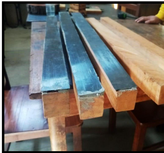
Figura 4.5: Probetas reforzadas. Fuente: Elaboración propia.
