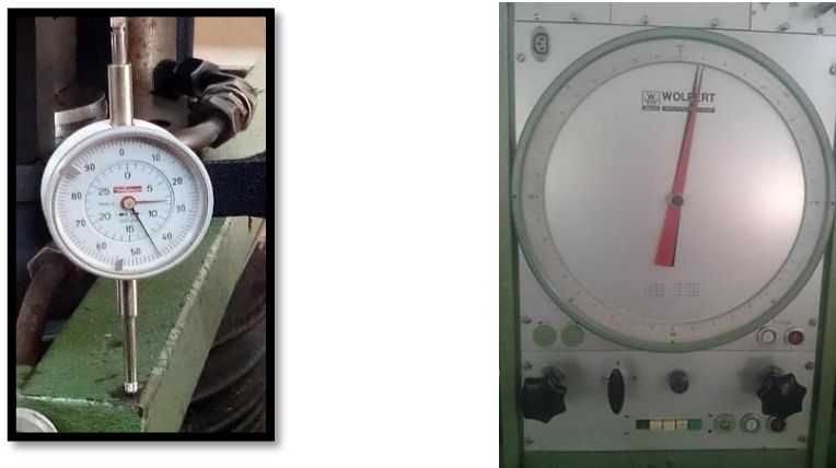
Figura 3.2: Deflectómetro y Medición de la fuerza resistente en la escala de la prensa Universal. Fuente: Elaboración propia.
