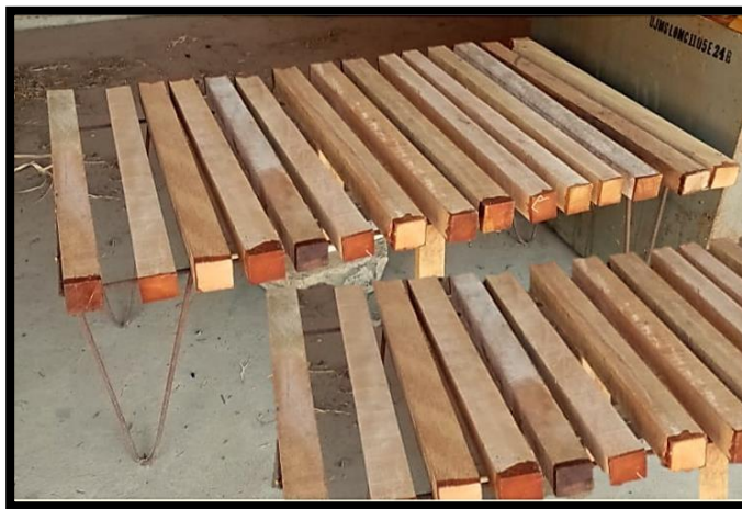
Figura 3.5: Probetas secadas al aire libre Fuente: Elaboración propia.
