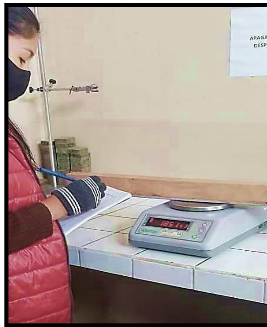
Figura 4.2: Proceso del pesado de las probetas reforzadas. Fuente: Elaboración propia.
