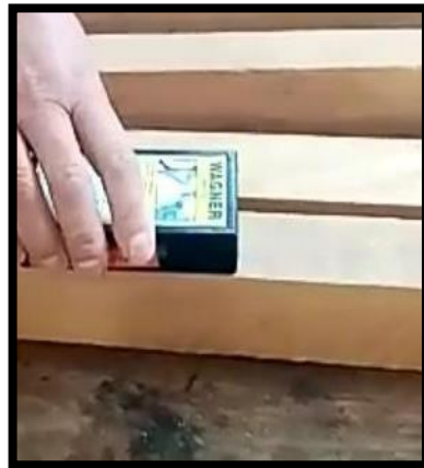
Figura 3.3: Medición de la humedad con xilohigrómetro. Fuente: Elaboración propia.
