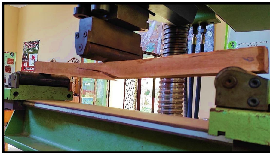
Figura 4.17: falla por flexión probeta sin refuerzo. Fuente: Elaboración propia
