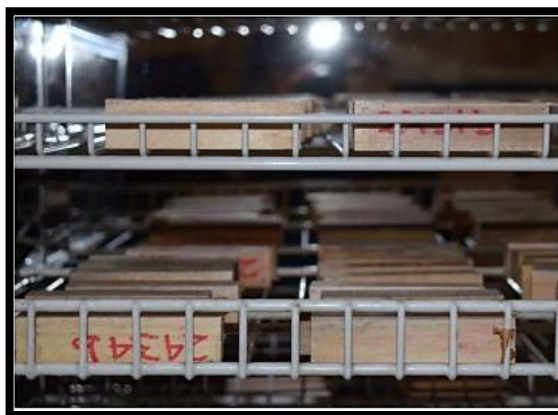
Figura 4.3: Galletas extraídas de las probetas, colocadas en estufa. Fuente: Elaboración propia
