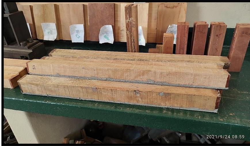
Fotografía N°2 Probetas con refuerzo antes del ensayo
