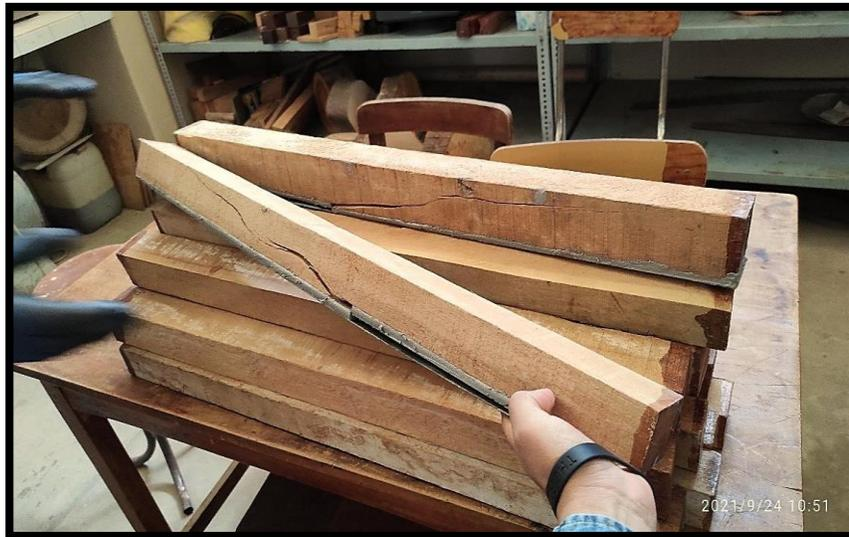
Fotografía N°3 Probetas con refuerzo después del ensayo
