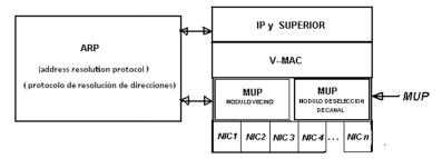
Figura II.19 Protocolo de unificación multiradio (MUP)
