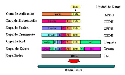
Figura II.2 Estructura del Modelo OSI
