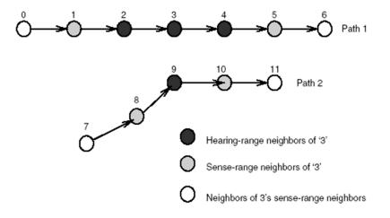
Figura II.27 La interferencia Intraflujo e Interflujo
