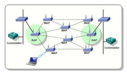
Figura IV.8 Diagrama de una Red Mesh Cisco
