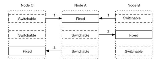
Figura II.25 Transmisión entre nodos
