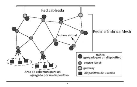
Figura II.26 Redes Mesh basadas en IEEE 802.11
