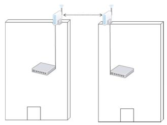
Figura II.14 Puente Inalámbrico
