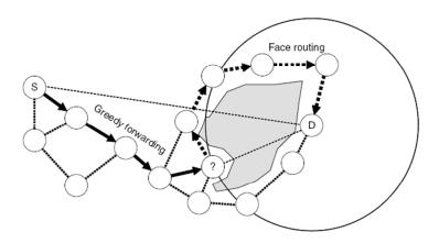
Figura II.29 Protocolos basados en posición (position-based)
